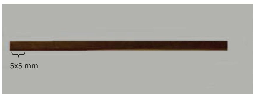
รูปที่ 10 Copper plate electrode ขนาด 6.0 x 0.5 cm พื้นที่ใช้งานขนาด 5x5 mm
