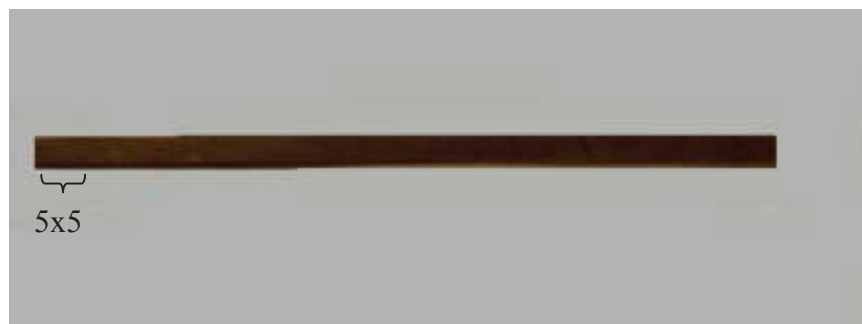
รูปที่ 36 Copper plate electrode ขนาด 6.0 x 0.5 cm พื้นที่ใช้งานขนาด 5 x 5 mm
