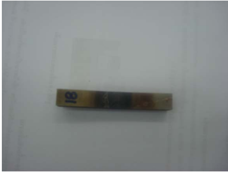
รูปที่ ข.5 แสดงขนาดชิ้นงานที่ด้วยเครื่องตัด Wire-Cut ยี่ห้อ CHARMILLES TECHNOLOGIES (รุ่น ROBOFIL 290) ให้ได้ขนาด 10 \times 70 \times 10 มิลลิเมตรก่อนบ่มแข็งละลายเฟส
