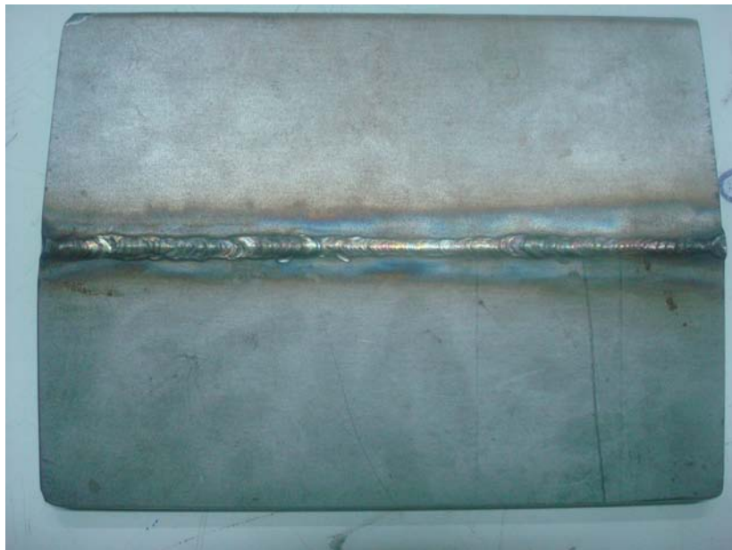
รูปที่ ข.2 แสดงชิ้นงานเชื่อมด้วยกระบวนการเชื่อมแบบแก๊สปกคลุม GTAW (Gas Tungsten Arc Welding) ด้านหน้า
