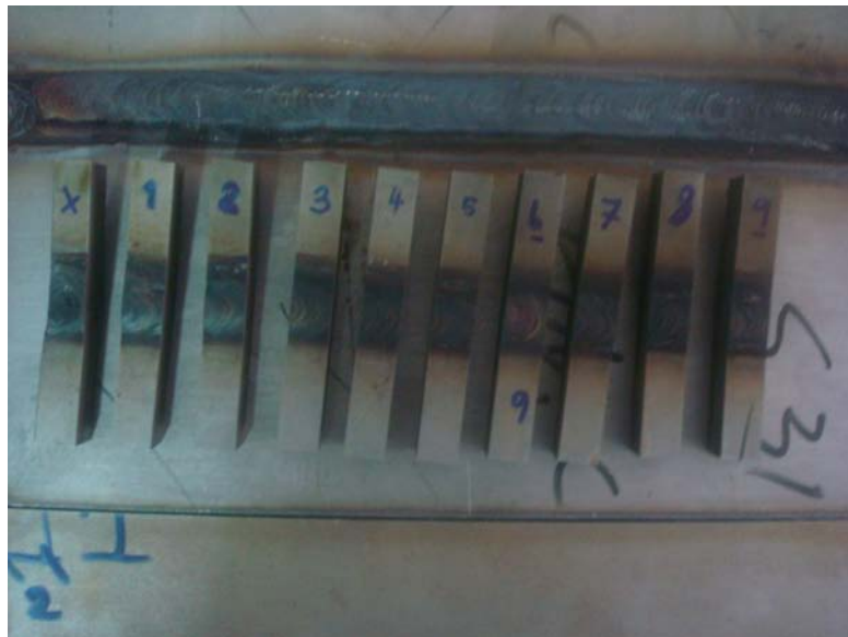
รูปที่ ข.4 แสดงขนาดชิ้นงานที่ตัดด้วยเครื่องตัด Wire-Cut ยี่ห้อ CHARMILLES TECHNOLOGIES (รุ่น ROBOFIL 290) ให้ได้ขนาด 10 \times 70 \times 10 มิลลิเมตร
