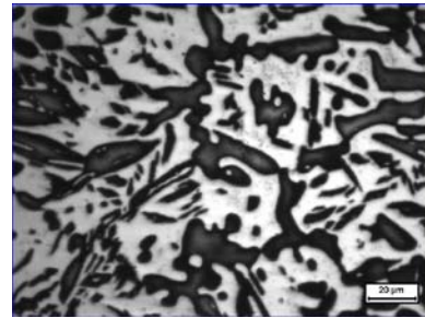
(2) บริเวณเขตอิทธิพลความร้อน Heat Affected Zone
