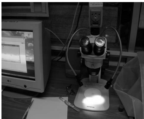
รูปที่ 3.6 แสดงชุดอุปกรณ์ถ่ายภาพด้วยกล้องสเตอริโอไมโครสโคป
