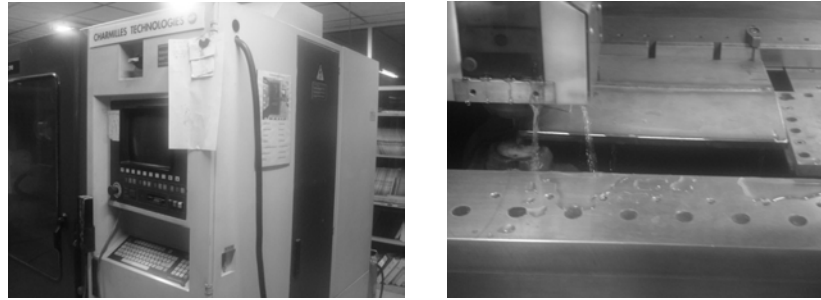
รูปที่ 3.9 การตัดชิ้นงานทดลองด้วยเครื่องตัด Wire-Cut
