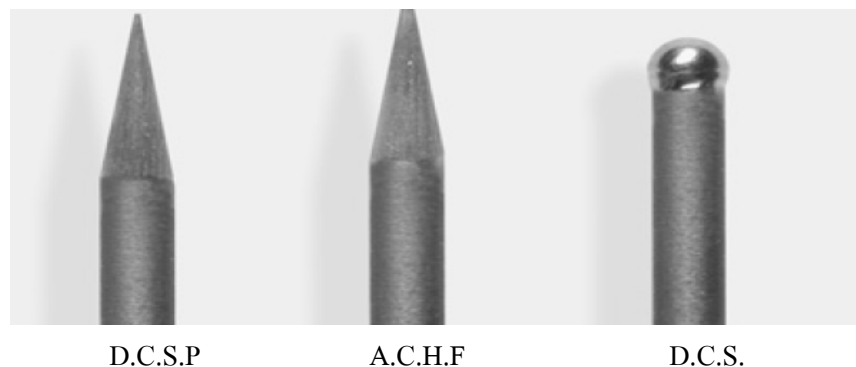
รูปที่ 2.18 แสดงปลายที่เจียรนัยแล้วของทั้งสแตนท์อิเล็กโทรดในการเชื่อมแต่ละแบบ [7]
