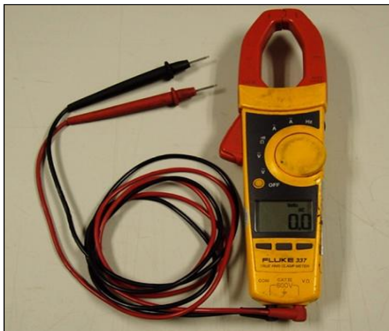
ภาพที่ 3.17 เครื่องวัดค่าทางไฟฟ้าชนิดคลิป์แอมป์ ผลิตภัณฑ์ FLUKE รุ่น 337
