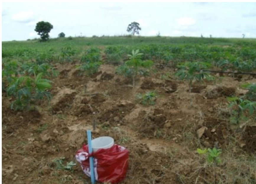
ภาพที่ ข3 การเก็บข้อมูลปริมาณน้ำฝน โดย Rain Gauge
