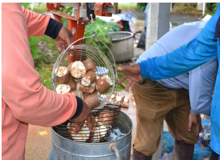
ภาพที่ ข6 การวัดปริมาณแป้งในหัวสด โดยวิธี Reinmann scale
