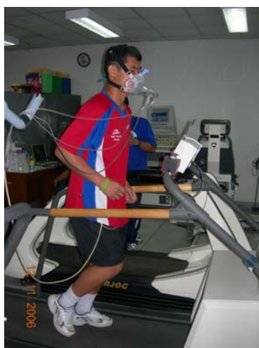
ภาพผนวกที่ ข6 แสดงการวัดความสามารถในการใช้ออกซิเจนด้วยเครื่องวิเคราะห์ก๊าซ
