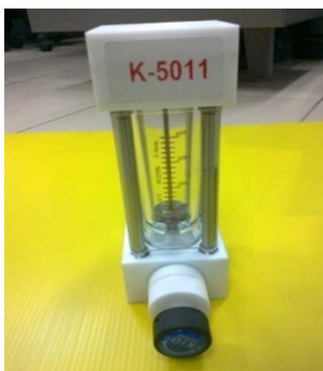
รูปที่ 3.14 แสดงเครื่องมือวัดอัตราการไหลเชิงปริมาตรของอากาศ
