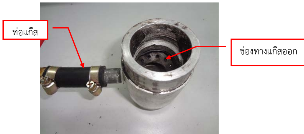
รูปที่ 3.7 แสดงอุปกรณ์ผสมแก๊สกับอากาศ (Gas mixer)
