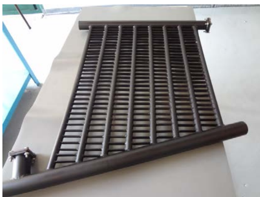
รูปที่ 3.6 แสดงคอนเดนเซอร์ (Condenser)
