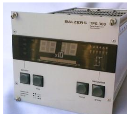
รูปที่ 3.17 แสดงลักษณะของเกจวัดความดัน Balzers TG300
