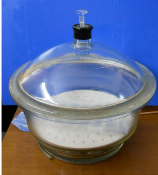
รูปที่ 3.23 โถแก้วความดันต่ำ [จากผู้เขียน]
