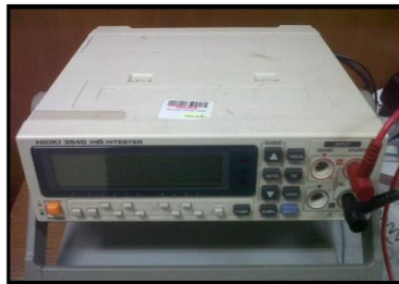
รูปที่ 3.4 ตัวจ่ายกระแสคงที่สำหรับการวัดค่าทางไฟฟ้าสภาพความต้านทานไฟฟ้า
