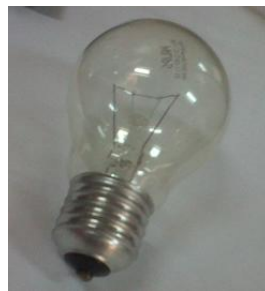
รูปที่ 3.8 หลอดไฟ 40W ใช้เป็นแหล่งให้ความร้อนแก่ชิ้นงาน
