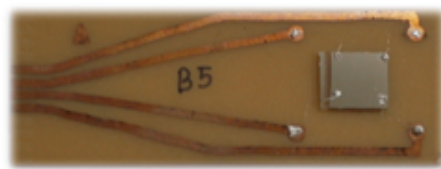
รูปที่ 3.6 ลักษณะลายทองแดงสำหรับวัดค่าความต้านทานแบบ 4 จุด บนแผ่นวงจรพิมพ์ และการเชื่อมต่อลวดเงินกับชิ้นงานลายวงจร
