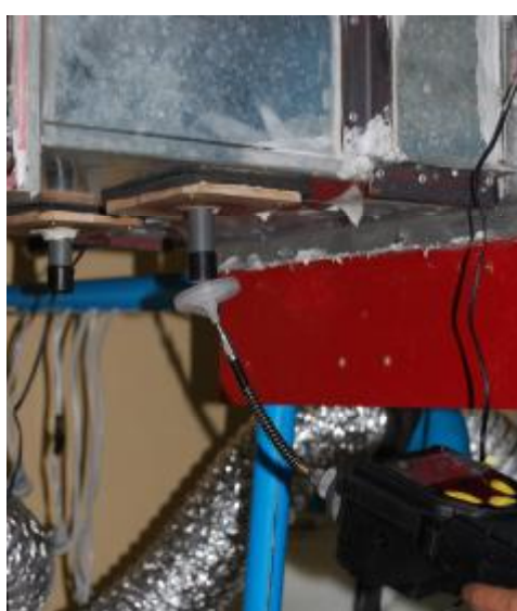
รูปที่ 15 การวัดความเข้มข้นของก๊าซมลพิษที่ตำแหน่งก่อนและหลังหลอดไฟเคลือบๆ ด้วยอุปกรณ์ ppbRAE
