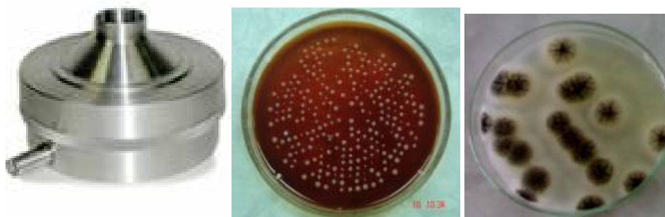
รูปที่ 12 Single-stage impactor และตัวอย่างจุลินทรีย์ที่เก็บได้จากการใช้ impactor
