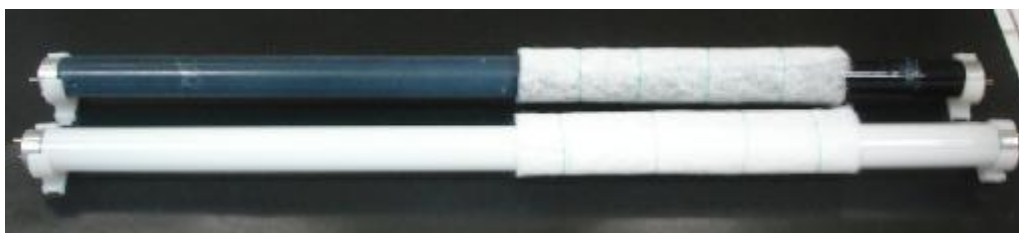
รูปที่ 13 หลอดไฟที่เคลือบด้วยไทเทเนียมไดออกไซด์โดยตรง และหลอดไฟที่พันด้วยแผ่นใยแก้วเคลือบ
