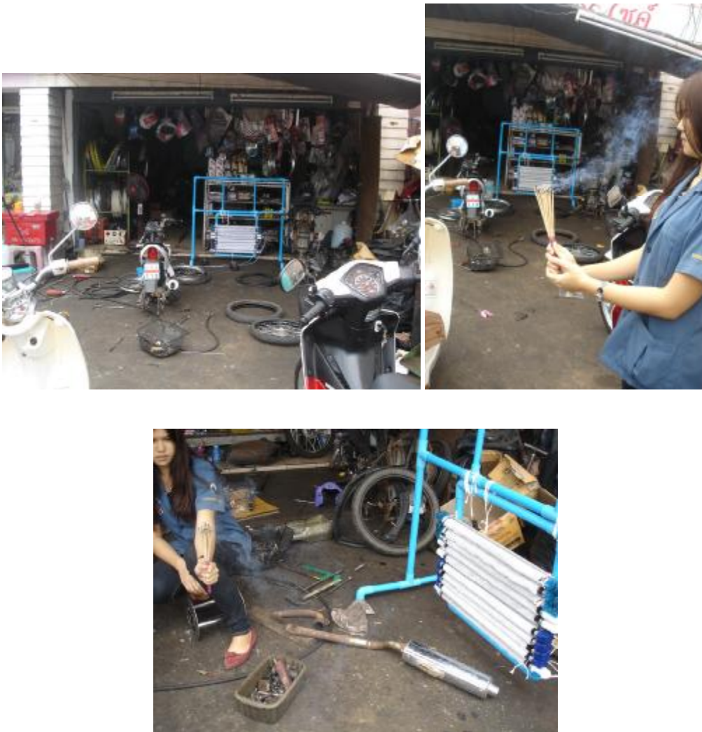
รูปที่ 16 การสลายสารอินทรีย์ที่ร้านซ่อมรถจักรยานยนต์โดยใช้แผงหลอดไฟพันด้วยแผ่นใยแก้วเคลือบฯ
