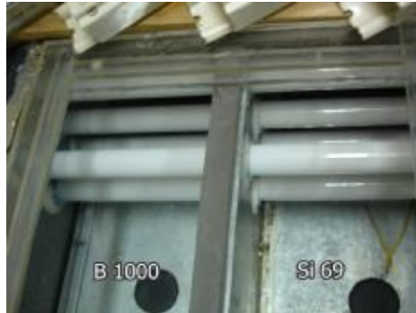
รูปที่ 2 หลอดไฟฟลูออเรสเซนต์เคลือบไทเทเนียมไดออกไซด์ที่ผสม 3% B1000 และ Silane-69 ใน chamber ทดลอง
