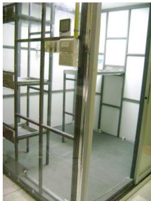
รูปที่ 9 ห้องทดลองที่ศึกษาเปรียบเทียบการวัดความเร็วลมในตำแหน่งต่างๆของห้อง
