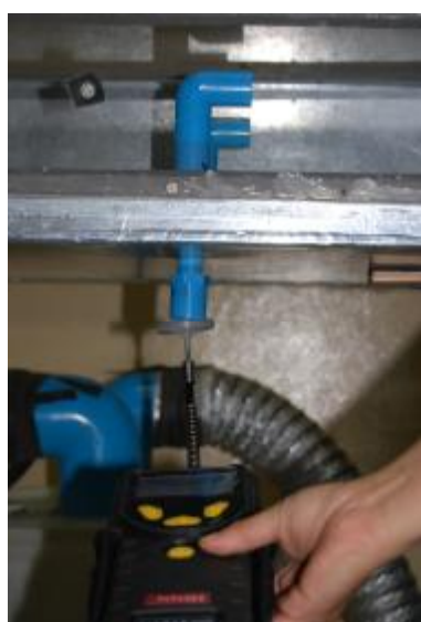
รูปที่ 15 การวัดความเข้มข้นของก๊าซมลพิษที่ตำแหน่งก่อนและหลังหลอดไฟเคลือบๆ ด้วยอุปกรณ์ ppbRAE
