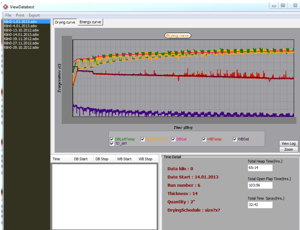
รูปที่ 5.18 การแสดงข้อมูลของโปรแกรมของสภาวะการอบของเตาอบไม้ยางพาราในอุตสาหกรรมตลอดการอบ
