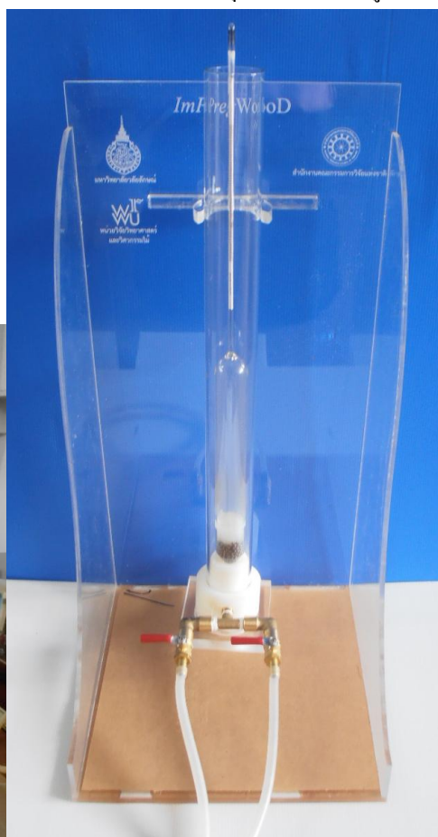
รูปที่ 4.1 ระบบวัดความถ่วงจำเพาะของสารละลายโบรอนสำหรับการใช้งานในโรงงานอุตสาหกรรม
