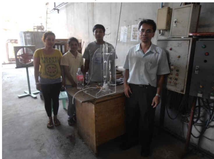
รูปที่ 4.10 ระบบควบคุมการอัดน้ำยาฆ่าเชื้อสำหรับบริษัท เขมมหาชัยพาราวัฏ จำกัด จังหวัดนครศรีธรรมราช ซึ่งประกอบไปด้วย เครื่องวัดความถ่วงจำเพาะความละเอียดสูง ชุดหลอดแก้วสำหรับถ่ายเทน้ำยา โซฟแวร์คอมพิวเตอร์สำหรับการคำนวณรวมแผ่นซีดี และคู่มือการใช้งาน
