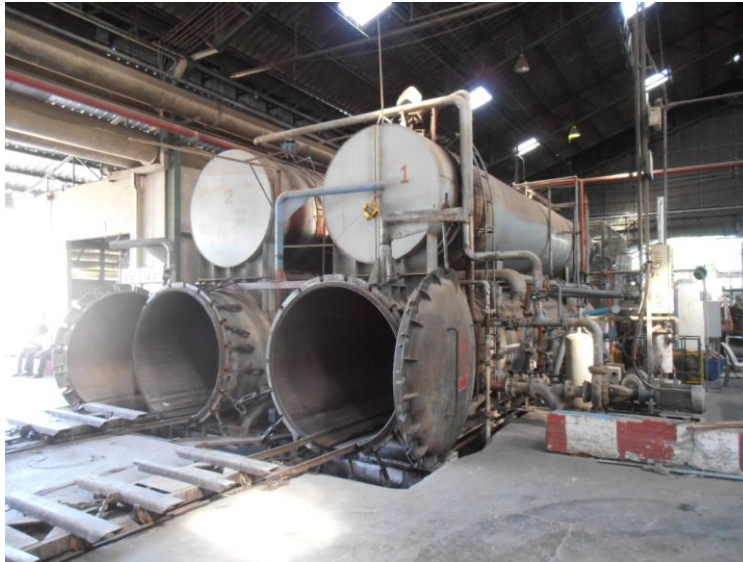
รูปที่ 4.5 ลักษณะของการเก็บน้ำยาในถังเก็บน้ำยาด้านบน
