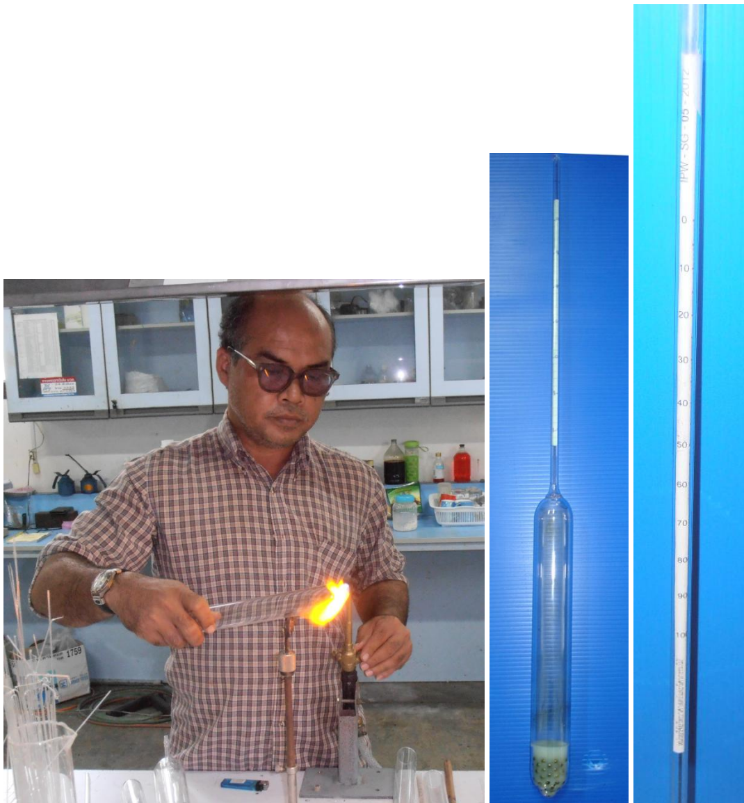
รูปที่ 4.2 ระบบวัดเครื่องวัดความถ่วงจำเพาะที่ออกแบบและสร้างขึ้นในงานวิจัยเพื่อวัดความถ่วงจำเพาะของสารละลายโบรอนที่ความเข้มข้นต่ำๆ
