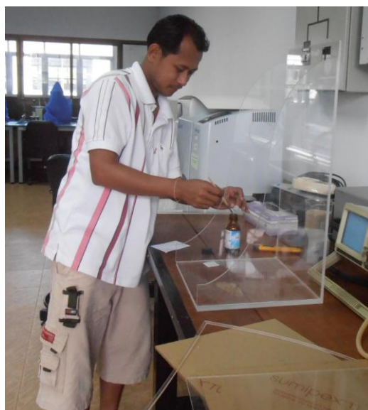
รูปที่ 4.1 ระบบวัดความถ่วงจำเพาะของสารละลายโบรอนสำหรับการใช้งานในโรงงานอุตสาหกรรม
