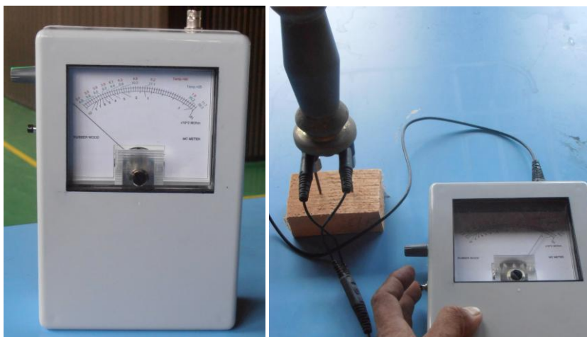
รูปที่ 5.2 เครื่องวัดความชื้นในไม้ที่พัฒนาขึ้น
