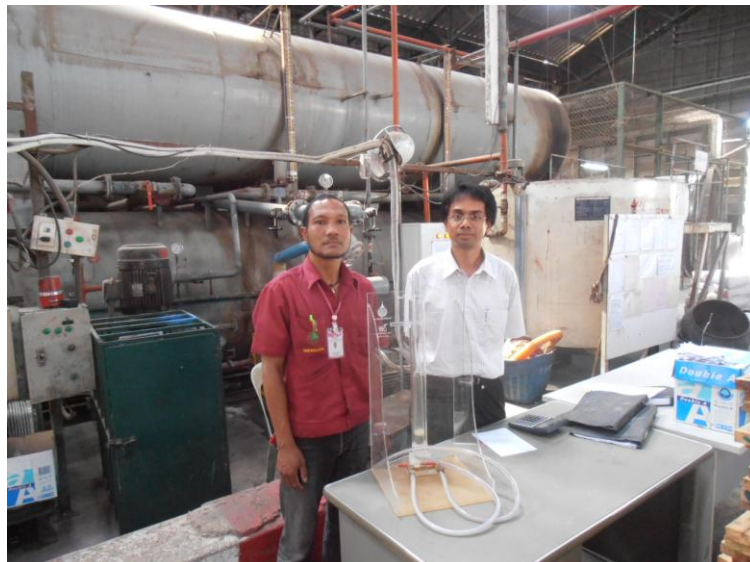
รูปที่ 4.8 ระบบควบคุมการอัดน้ำยาไม้มะพร้าวสำหรับบริษัทวีดีเวอร์คยูไนเต็ด จำกัด ซึ่งประกอบไปด้วย เครื่องวัดความถ่วงจำเพาะความละเอียดสูง ชุดหลอดแก้วสำหรับถ่ายเทน้ำยา โซฟแวร์คอมพิวเตอร์สำหรับการคำนวณรวมแผ่นซีดี และคู่มือการใช้งาน
