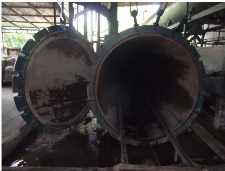
รูปที่ 4.6 ลักษณะของการใช้ถังพักด้านล่างในการเก็บน้ำยาแทนถังเก็บน้ำยาด้านบน
