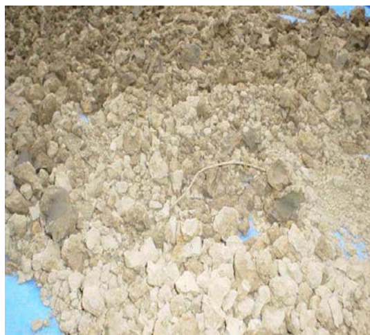
ภาพที่ 2-4 ตะกอนประปา
