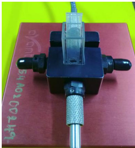
รูปที่ 3.8 ภาพแสดงการวางตำแหน่งของกรอบยึดแผ่นฟิโอสเซ็นเซอร์เมมเบรนในคิวเวท
