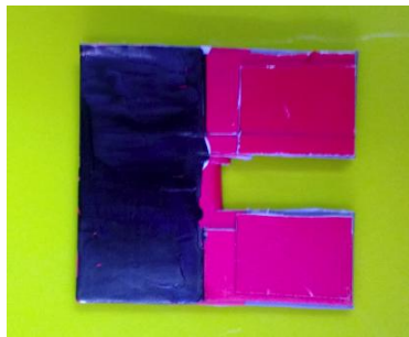
รูปที่ 3.4 แถบยึดเซ็นเซอร์กรอบกระดาษแผ่นฟิโอสเซ็นเซอร์เมมเบรน
