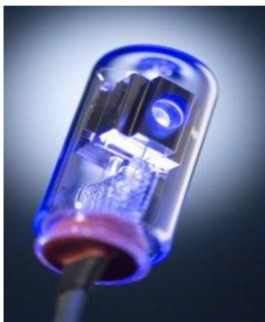
รูปที่ 2.15 แสดงภาพตัวอย่างของแหล่งกำเนิดแสงแบบหลอดคิวดิวเทอเรียมและหลอดทังสเตนตามลำดับ [22]
