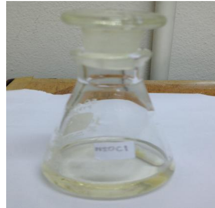
(ข) สารละลายผสมไนลอน6/ไคโตซาน 20:1 (5%wt. ไคโตซาน)
