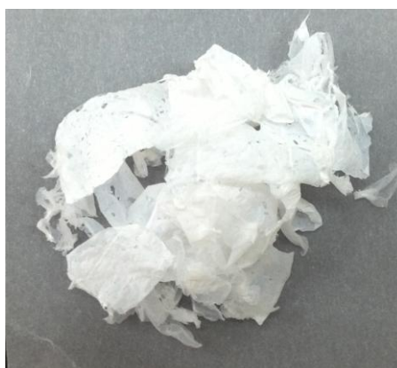
รูปที่ 4.20 ภาพถ่ายของเส้นใยนาโนผสมไนลอน6/ไคโตซาน ที่อัตราส่วน 20:3 (15wt. ไคโตซาน) สำหรับเป็นวัสดุดูดซับ
