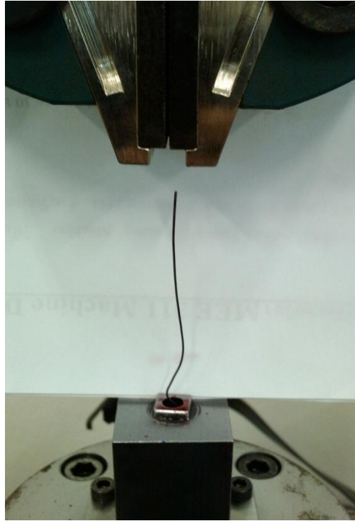
รูปที่ 5.24 ลวดโลหะผสมจำรูปนิกเกิล – ไทเทเนียมที่ขาดบริเวณปากจับยึดชิ้นงานเมื่อประยุกต์ใช้การ สันสะท้อนด้วยความถี่สูง
