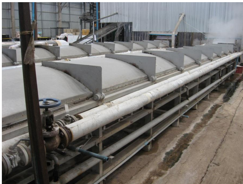
รูปที่ ค.7 เครื่องนึ่งก๊วยเตี๋ยวด้วยไอน้ำ
