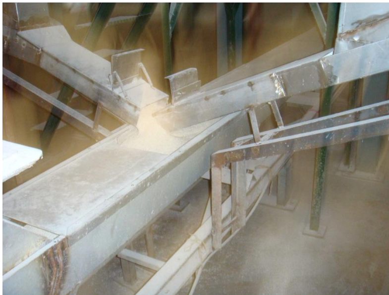
รูปที่ ค.1 แสดงการลำเลียงส่วนผสมข้าวเข้าสู่กระบวนการผลิต
