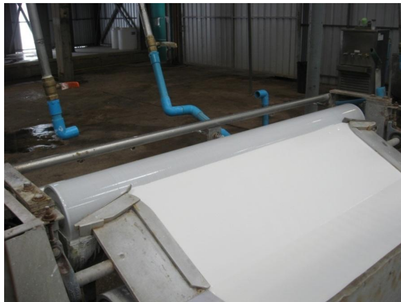
รูปที่ ค.6 แสดงลักษณะการป้อนน้ำแป้งลงบนสายพานนิ่งก้วยเดี่ยว
