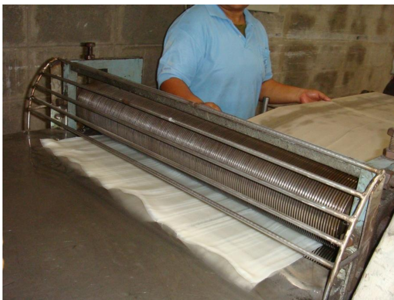
รูปที่ ค.10 แสดงกระบวนการตัดเส้นกล้วยเดี่ยวตามขนาดที่ต้องการ
