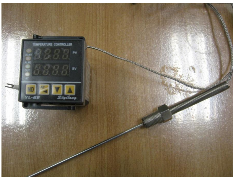
รูปที่ ข.10 ตัวแสดงอุณหภูมิและเทอร์โมคัปเปิ้ลชนิดเค (type k)
