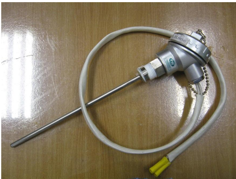
รูปที่ ข.9 เทอร์โมคัปเปิ้ลชนิดเค (type k)
