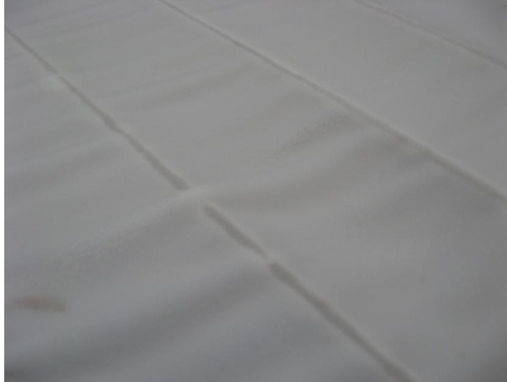
รูปที่ 5.4 แสดงลักษณะของแผ่นกัวยืดจากการนึ่งที่อุณหภูมิน้ำแป้งก่อนนึ่ง 60 องศาเซลเซียส และความเร็วสายพาน 9 เมตรต่อนาที ที่ความหนา 1.5 มิลลิเมตร
