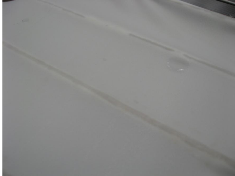
รูปที่ 5.3 แสดงลักษณะของแผ่นกัวยืดจากการนึ่งที่อุณหภูมิน้ำแข็งก่อนนึ่ง 60 องศาเซลเซียส และความเร็วสายพาน 10 เมตรต่อนาที ที่ความหนา 1 มิลลิเมตร
