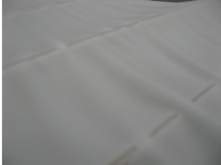
รูปที่ 5.2 แสดงลักษณะของแผ่นกัวยืดจากการนึ่งที่อุณหภูมิน้ำแข็งก่อนนึ่ง 60 องศาเซลเซียส และความเร็วสายพาน 12 เมตรต่อนาที ที่ความหนา 0.7 มิลลิเมตร
