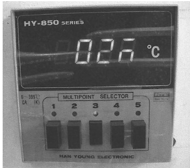
รูปที่ 3.10 เครื่องวัดอุณหภูมิแบบ 5 ช่องสัญญาณ [15]
