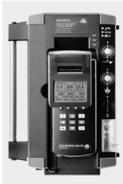
รูปที่ 3.11 เครื่องวัดค่าประสิทธิภาพการเผาไหม้ Testo 350XL
