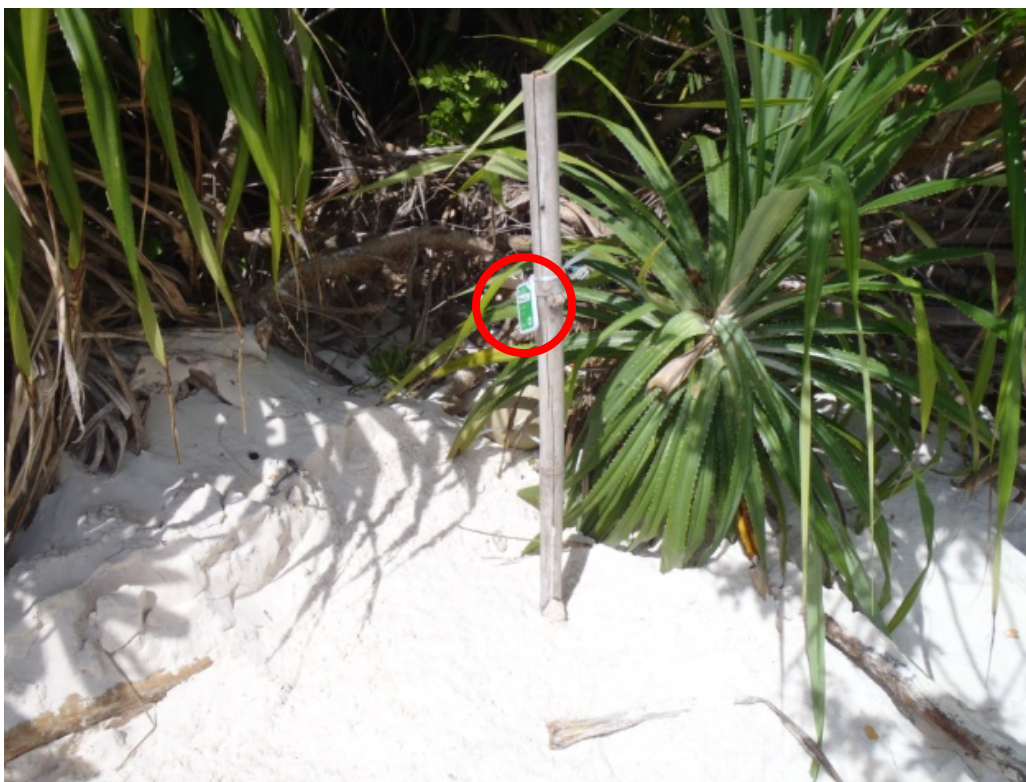
ภาพที่ 4: ตำแหน่งการวางเครื่องบันทึกอุณหภูมิต่อเนื่องทั้งที่ปากหลุมเพื่อบันทึกอุณหภูมิอากาศ (วงกลมสีแดง) และ ที่ก้นหลุมเพื่อบันทึกอุณหภูมิตรายในหลุม (ไม่แสดงในภาพ)
