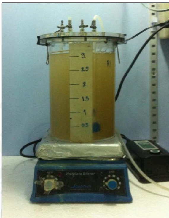
ภาพที่ 27 ถังปฏิกิริยาเอสบีอาร์ (SBR) ขนาด 3 ลิตรที่ใช้ในการทดลอง
