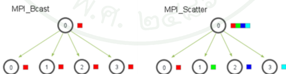
ภาพที่ 2 ความแตกต่างของทำงานระหว่าง MPI_Bcast และ MPI_Scatter
