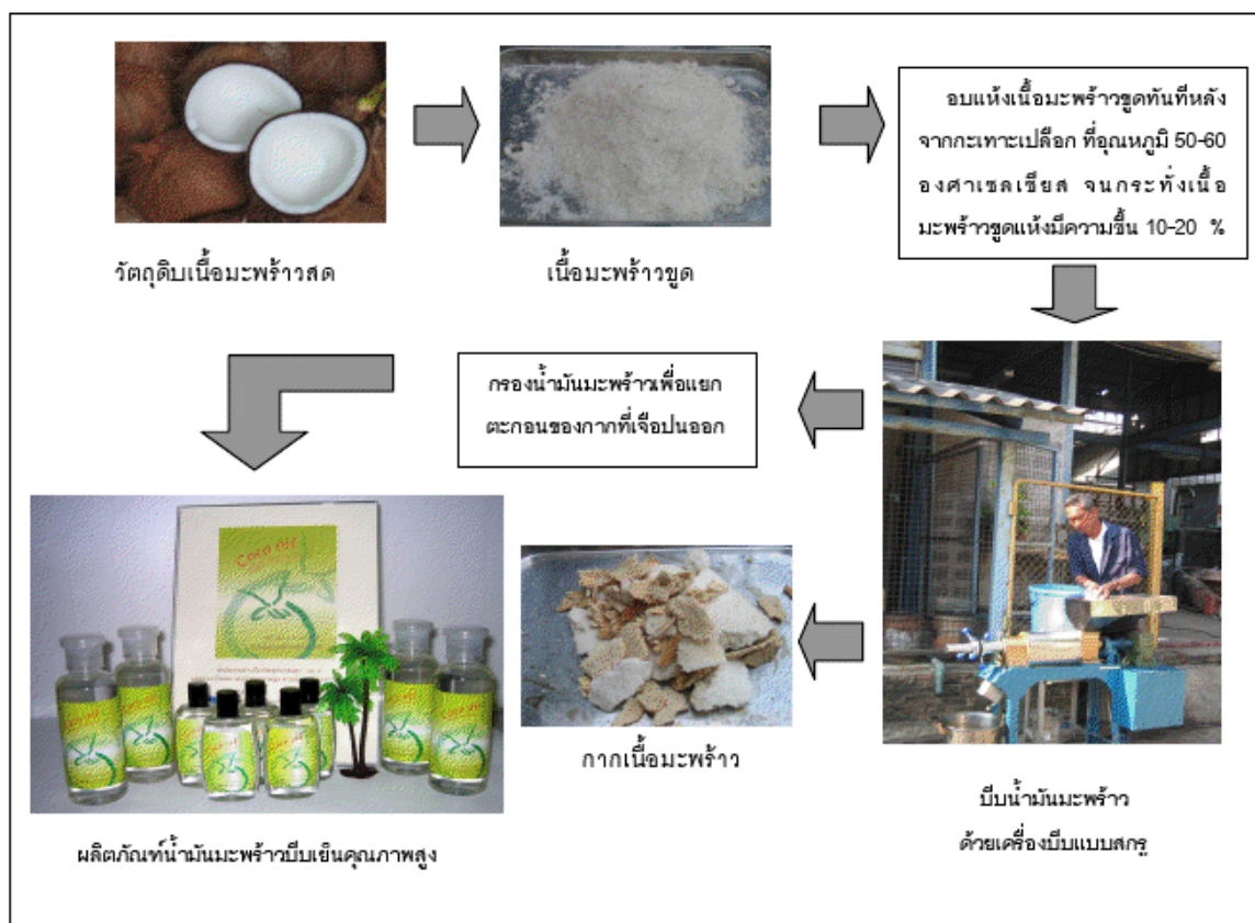
ภาพที่ 4 การสกัดน้ำมันมะพร้าวโดยใช้เครื่องบีบแบบสกรู (screw type press)
