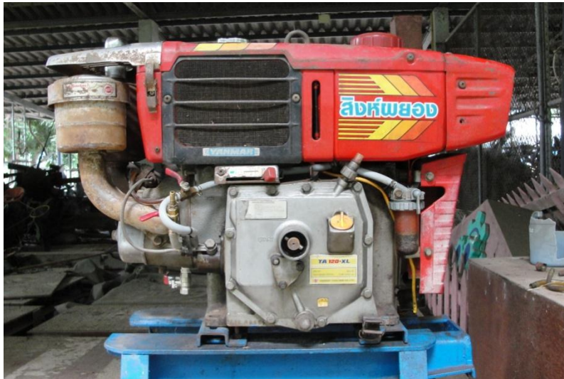
ภาพที่ 12 เครื่องยนต์ดีเซลสูบเดี่ยว ยี่ห้อ YANMAR รุ่น TA 120-XL ขนาด 12 แรงม้า
