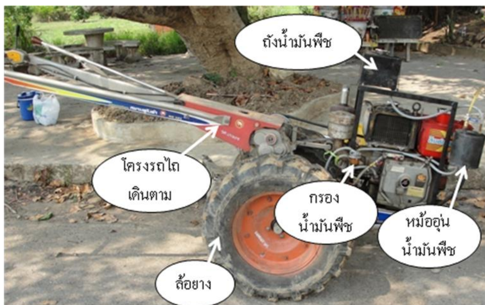
ภาพที่ 21 เครื่องยนต์ดีเซลสูบเดียว ยี่ห้อ YANMAR รุ่น TA 120-XL ขนาด 12 แรงม้า ติดตั้งบนรถไถเดินตาม (ล้อยาง)
