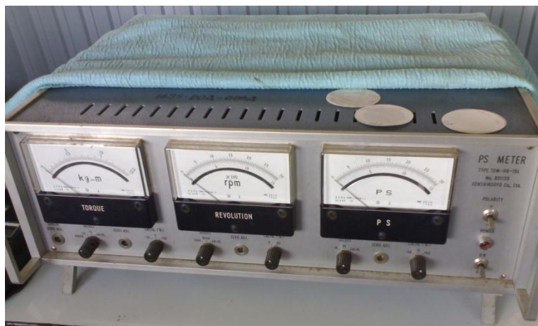
ภาพที่ 16 PS Meter , Denshigokyo รุ่น TDM-HR-15L สำหรับวัดค่าแรงบิดของ Dynamometer
