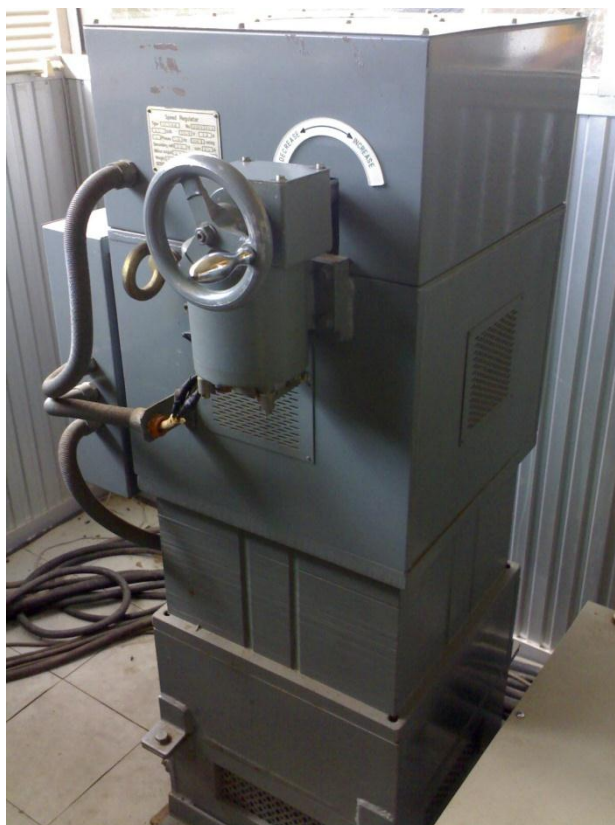
ภาพที่ 14 Speed Regulator สำหรับ เพิ่ม – ลด ภาระงานแก่เครื่องยนต์
