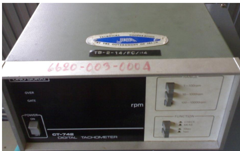
ภาพที่ 18 DIGITAL TACHOMETER , ONO SOKKI รุ่น CT-742 สำหรับวัดความเร็วรอบเครื่องยนต์
