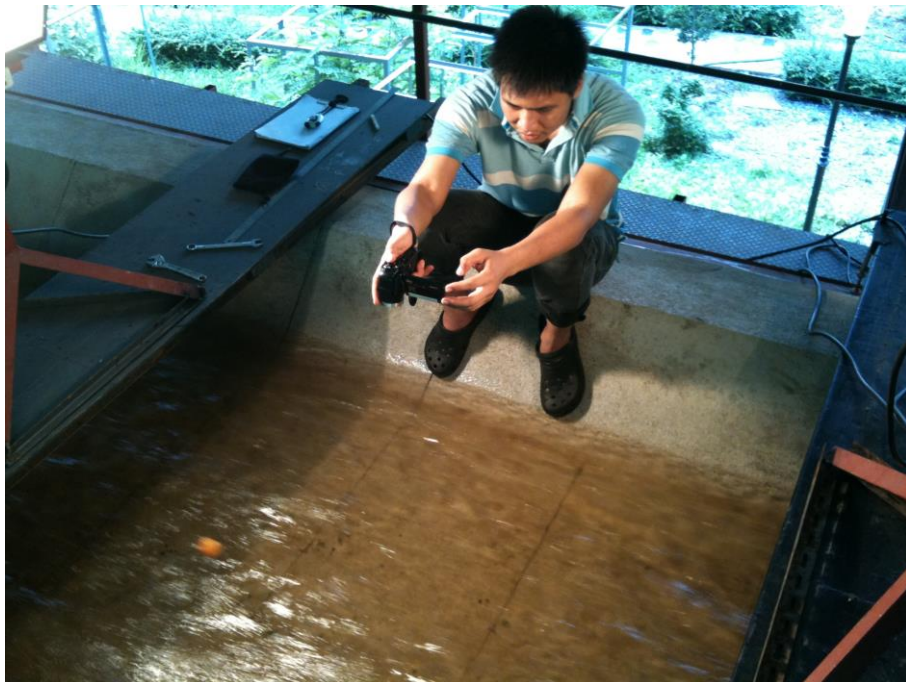
รูปที่ 2.4 รูปการถ่ายภาพแนวตรงตั้งฉากกับผิวน้ำ
