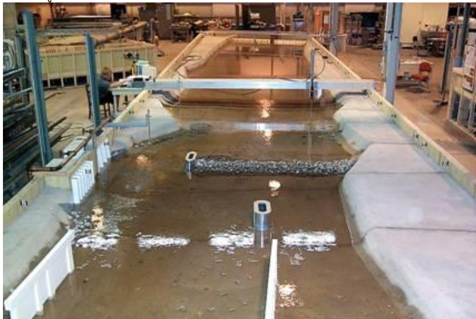
รูปที่ 1.7 แบบจำลองภูมิศาสตร์เพื่อจำลองการไหลของน้ำ *M. Muste, A. A. Kruger, and A. Bradley
