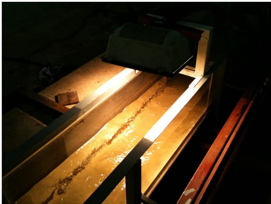
รูปที่ 2.6 การถ่ายภาพผิวน้ำโดยใช้แหล่งจ่ายแสงหนึ่งทาง
