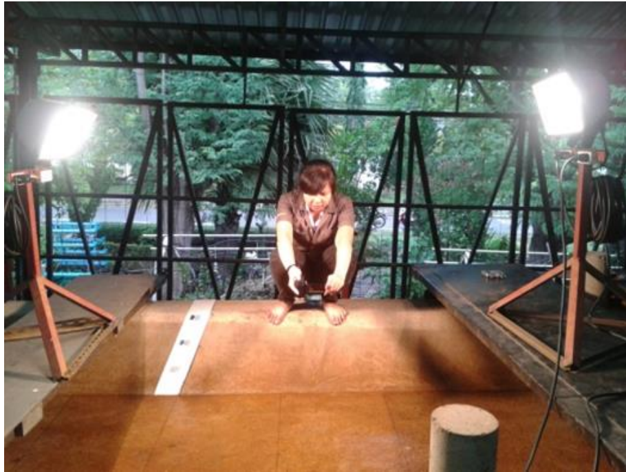
รูปที่ 2.5 การถ่ายภาพแนวเอียงกับผิวน้ำโดยใช้แหล่งจ่ายแสงสองทาง
