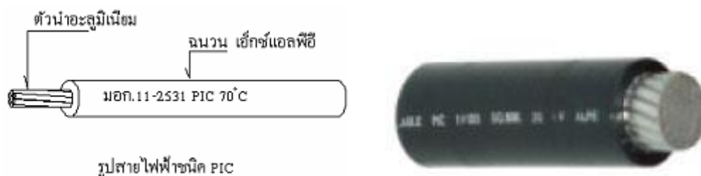
ภาพที่ 5 สายหุ้มฉนวนไม่เต็มพิกัด (PIC)
