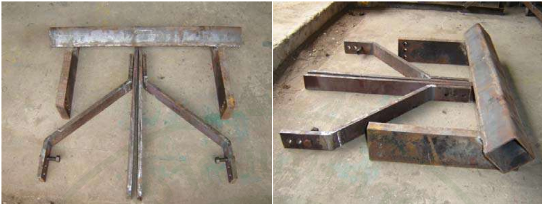
ภาพที่ 43 ก้านพนมและโครงยึดระหว่างคานขาไถ
