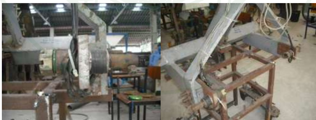
ภาพที่ 53 Lower Link Pins Transducer
