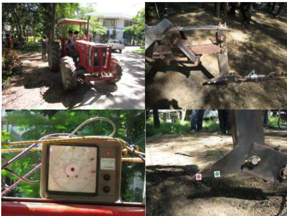
ภาพที่ 70 การทดสอบหาระยะยกตัวชาไถแบบที่ 1
