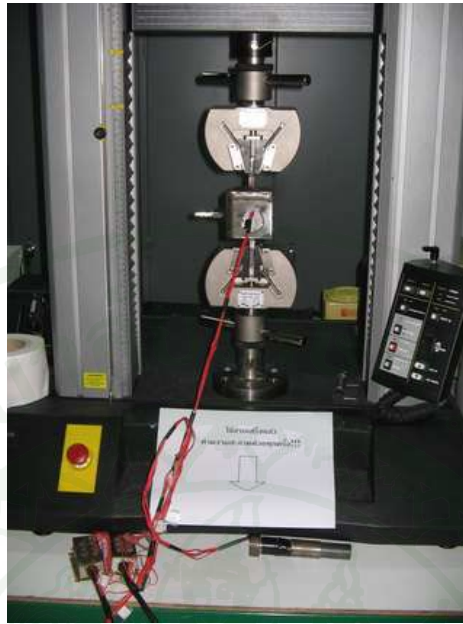
ภาพผนวกที่ ก1 การ Calibration ชุด Lower Link Pins Transducer
