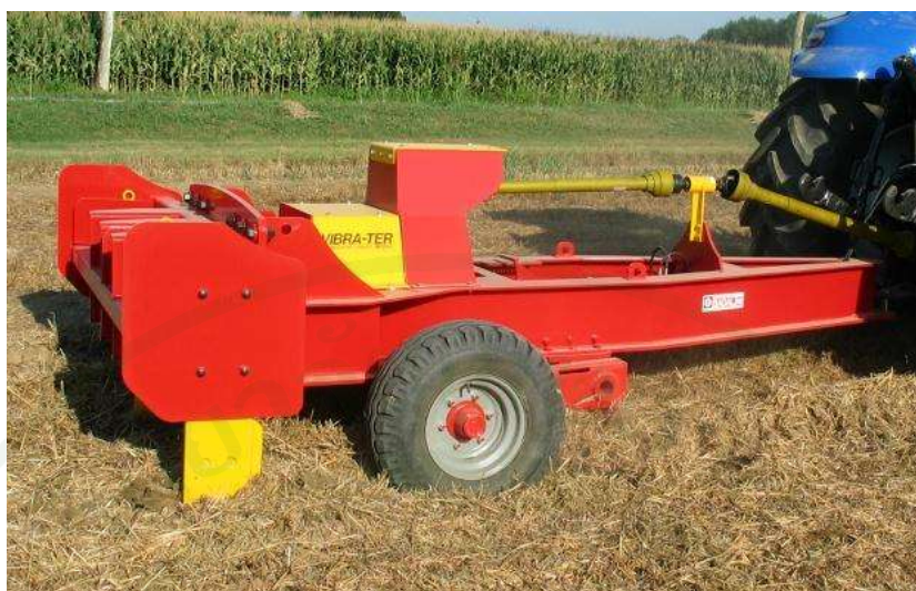
ภาพที่ 8 ขาไถระเบิดดินดานแบบสั่นเฉพาะขาไถ
