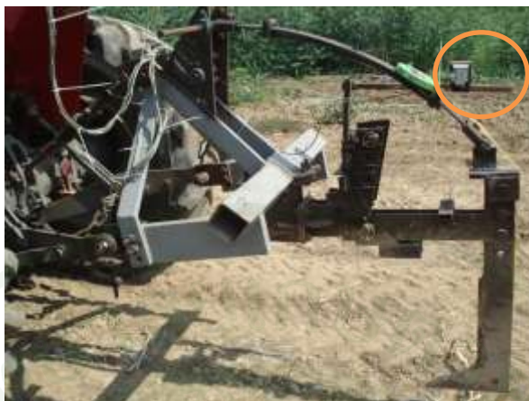
ภาพที่ 63 การวัดระยะยกตัวชาโถด้วย Displacement Transducer
