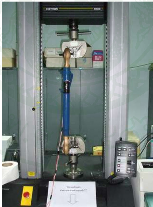
ภาพผนวกที่ ก2 การ Calibration ชุด Top Link Transducer
