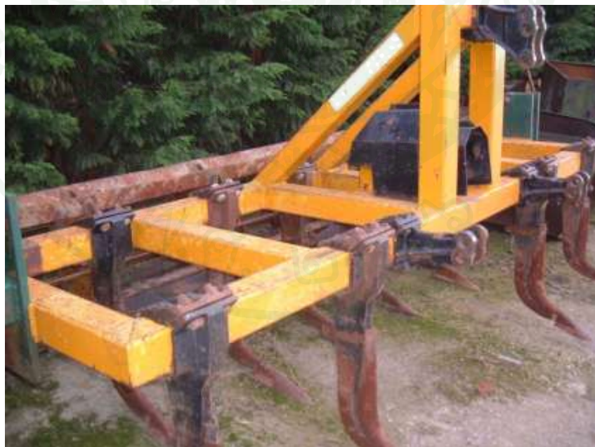
ภาพที่ 7 ขาไถระเบิดดินดานแบบสั่นทั้งโครง
