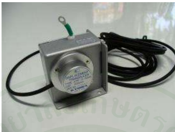
ภาพที่ 52 อุปกรณ์ Displacement Transducer
