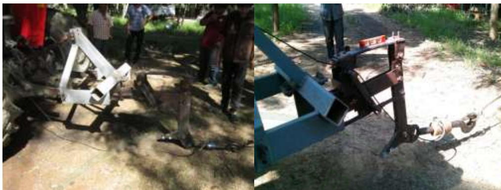
ภาพที่ 61 แสดงการต่อ Load Cell เข้ากับปลายขาไถ
