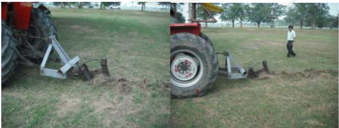
ภาพที่ 69 การยกตัวขาไถแบบที่ 1 ขณะไม่มีสิ่งกีดขวางในดิน
