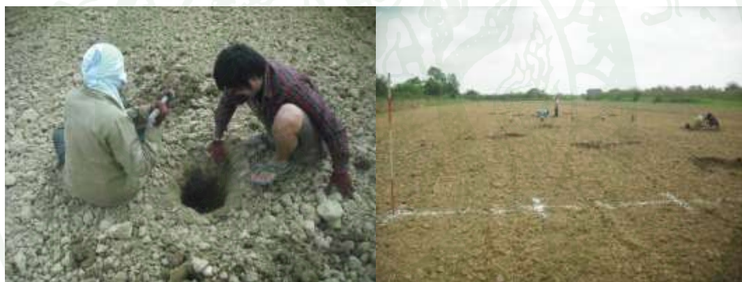
ภาพที่ 51 การขุดหลุมเพื่อเก็บตัวอย่างดินที่ระดับความลึกต่างๆ
