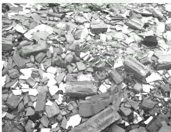
ภาพผนวกที่ ๖ ลักษณะการผสมกันของเศษยิปซัม เศษกระเบื้อง เศษอิฐและคอนกรีต
