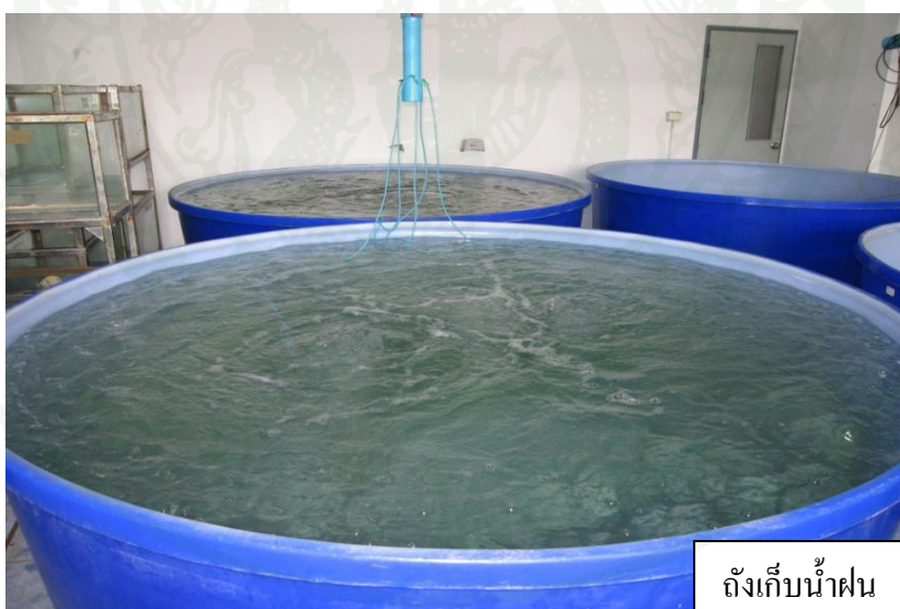
ภาพที่ 4 ถังไฟเบอร์กลาส ขนาด 1,000 ลิตรสำหรับเก็บน้ำฝนที่ใช้ในการทดลอง
