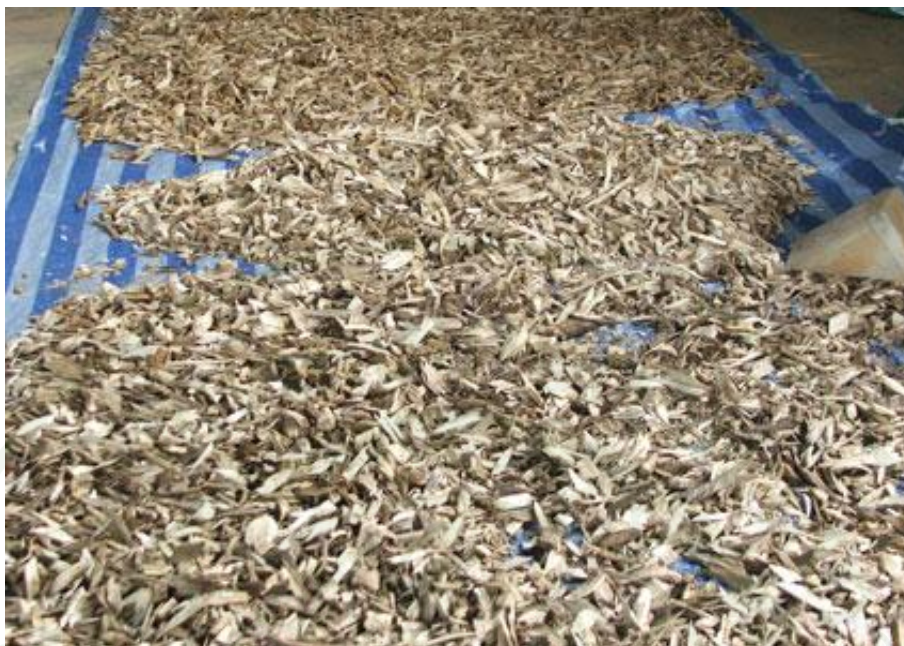
ภาพที่ 3 การนำชิ้นไม้สับไปผึ่งแดดก่อนนำไปกลั่น
