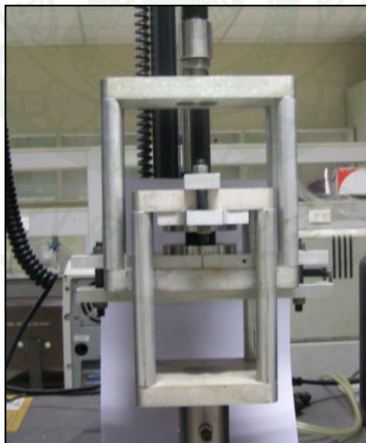
ภาพที่ 40 อุปกรณ์ยึดจับชิ้นงานสำหรับการทดสอบแรงกดในแนวแกนเดียว
