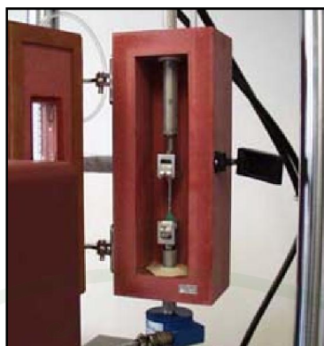
ภาพที่ 4 แสดงการทดสอบแบบแรงดึงในแนวแกนเดียว
