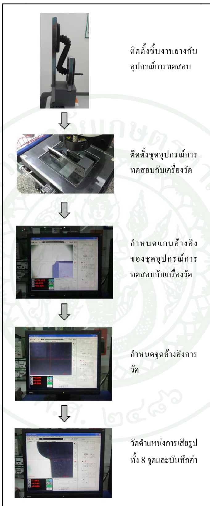
ภาพที่ 50 วิธีการวัดการเสีรูปของชิ้นงาน
