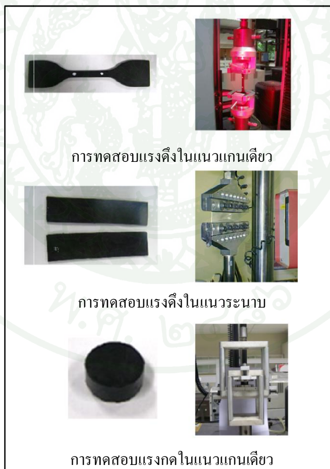
ภาพที่ 46 การทดสอบเพื่อหาค่าสมบัติทางกายภาพของยาง
