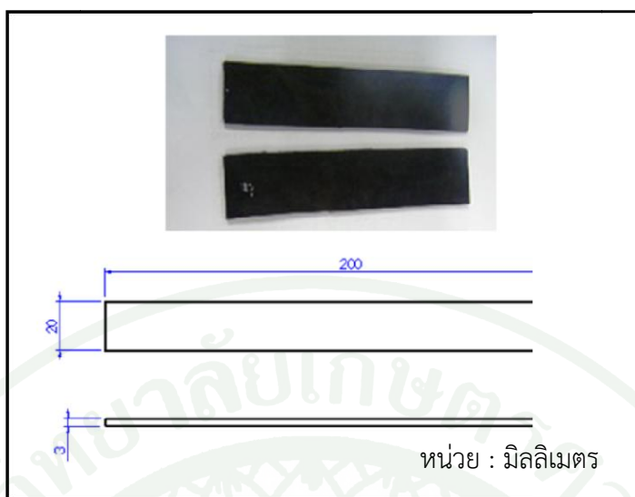
ภาพที่ 35 ชิ้นงานทดสอบสมบัติแรงดึงในแนวระนาบ
