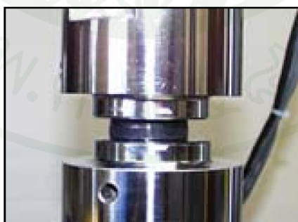
ภาพที่ 5 แสดงการทดสอบแบบแรงกดในแนวแกนเดียว
