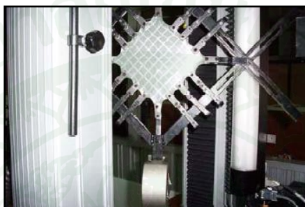
ภาพที่ 9 แสดงชุดอุปกรณ์ในการทดสอบแรงดึงสองแกนเท่ากันสำหรับขึ้นทดสอบแบบแผ่น
