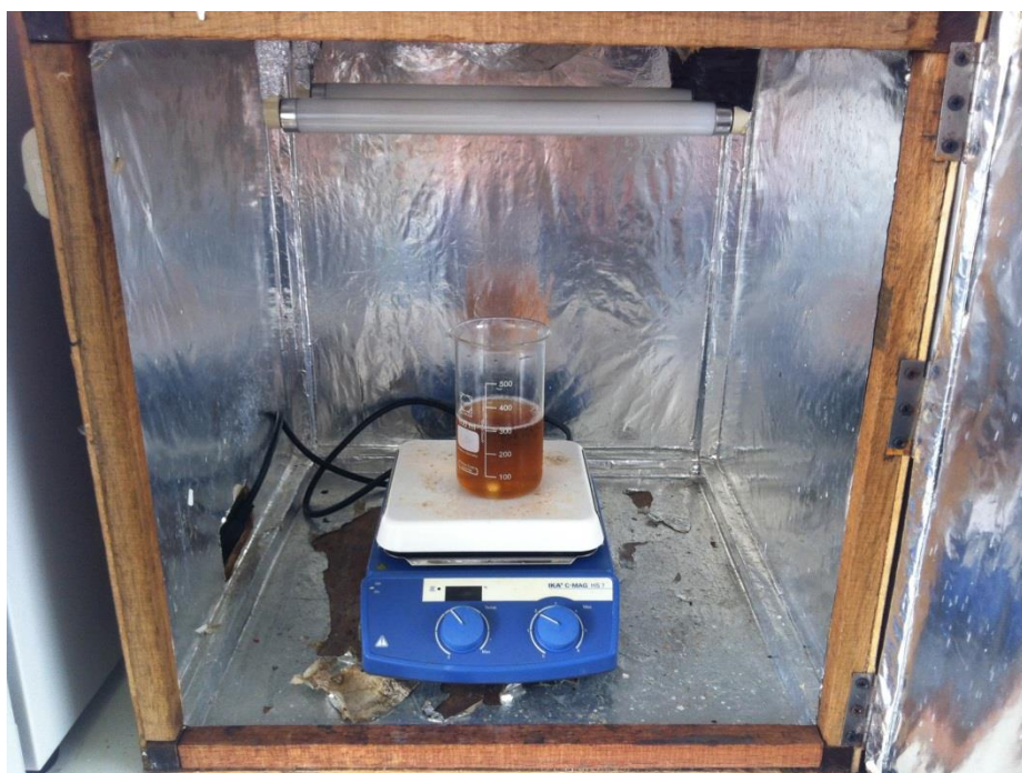
ภาพที่ 5 ไดอะแกรมของเครื่องปฏิกรณ์แบบกะที่ใช้ในการทดลอง
