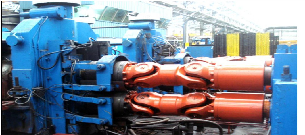
ภาพผนวกที่ 2 แสดงลักษณะของ Adjust Coupling เพื่อปรับเกลียวของเหล็กให้ตรงกัน
