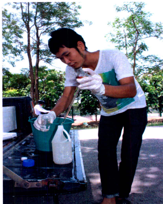
ภาพที่ 4 วิธีการเก็บตัวอย่างเพื่อนำไปวิเคราะห์ทางเคมี (โลหะหนัก)ในห้องปฏิบัติการ
