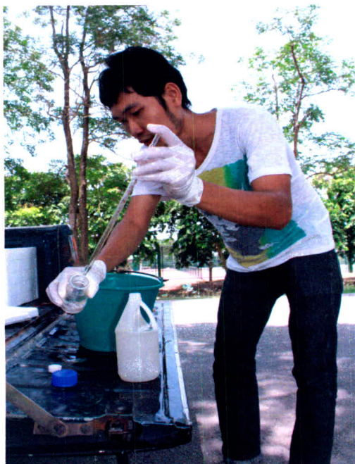
ภาพที่ 4 วิธีการเก็บตัวอย่างเพื่อนำไปวิเคราะห์ทางเคมี (โลหะหนัก)ในห้องปฏิบัติการ
