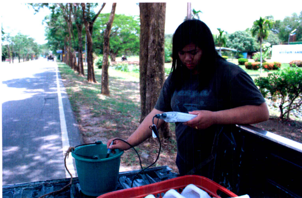
ภาพที่ 6 การวัดค่า pH และอุณหภูมิ ด้วยเครื่อง pH Meter
