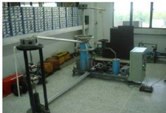
รูปที่ 1.2 หม้อแปลงเทสลาแบบดั้งเดิม
