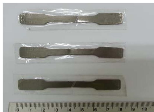
รูปที่ 4.15 ลักษณะชิ้นงานรีดเย็นของโลหะผสม Ti-12.5Mo-5Nb หลังผ่านการทดสอบแรงดึง
