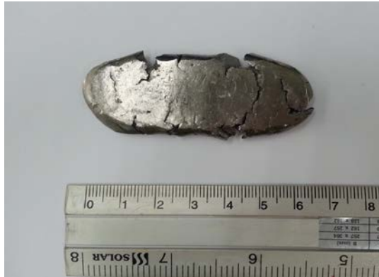
รูปที่ 4.11 ลักษณะการแตกของอินกอต Ti-12.5Mo ระหว่างรีดเย็น
