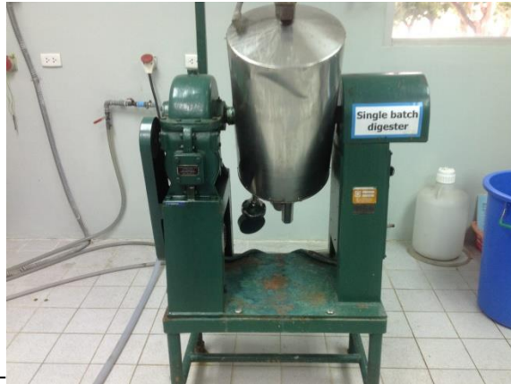
รูปที่ 3.4 หม้อต้มเยื่อแบบระบบปิด (Single Batch Digester)
