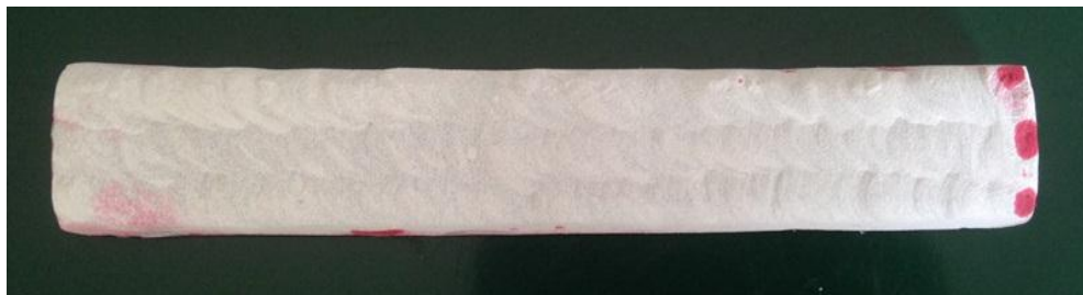
รูปที่ 4.1 ตัวอย่างการทดสอบด้วยวิธีสารแทรกซึมกับชิ้นงานผ่านสร้างผิวแข็งสำเร็จด้วยกระบวนการเชื่อมพอกผิวแข็ง
