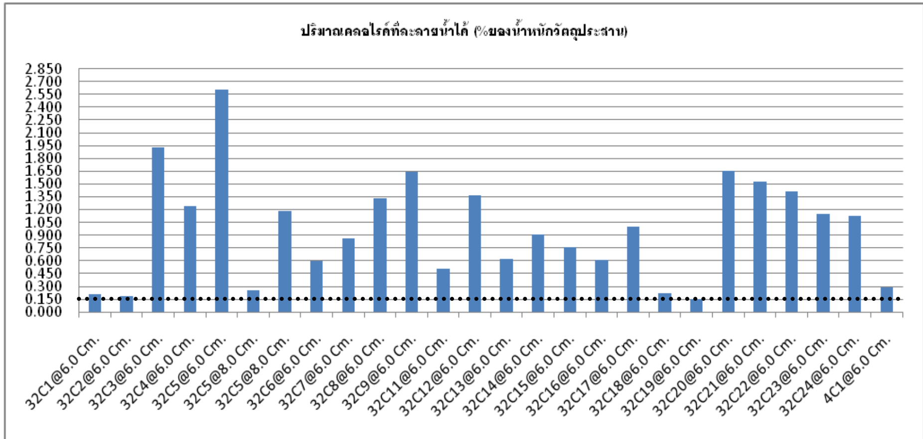
กราฟที่ 16 แสดงปริมาณคลอไรด์ที่ละลายน้ำได้ (% ของน้ำหนักวัสดุประสาน) กองยานพาหนะอาคาร อาคารที่ 2 ที่ความลึก 6.0 cm
