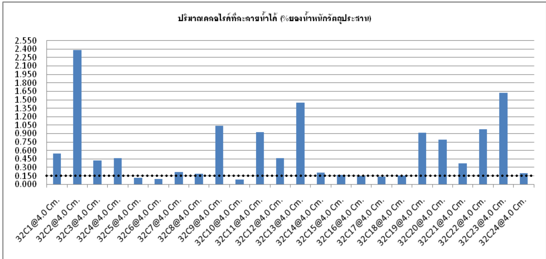
กราฟที่ 16 แสดงปริมาณคลอไรด์ที่ละลายน้ำได้ (% ของน้ำหนักวัสดุประสาน) กองยานพาหนะอาคาร อาคารที่ 2 ที่ความลึก 4.0 cm
