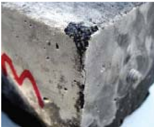
รูปที่ 1-2 ลักษณะการเปื่อยยุ่ยของคอนกรีตจากการกัดกร่อนของซัลเฟต
