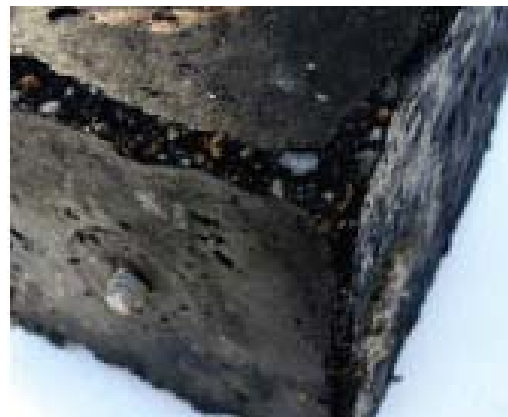
รูปที่ 1-2 ลักษณะการเปื่อยยุ่ยของคอนกรีตจากการกัดกร่อนของซัลเฟต
