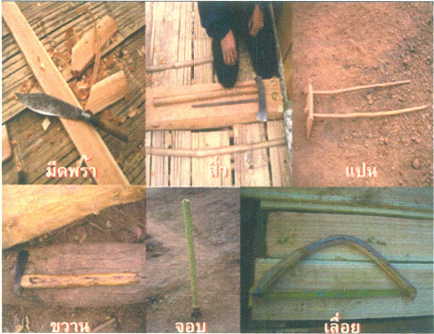
ภาพที่ 3.24 แสดงอุปกรณ์ในการสร้างเรือน ที่มา : จากการสำรวจภาคสนามโดย สัณชัย สุพิพัฒน์มงคล
