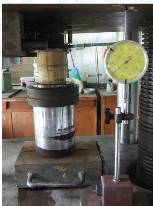
ภาพผนวกที่ 6 การทดสอบแรงอัดขนานเส้นหาความสัมพันธ์ระหว่างความเค้น-ความเครียด
