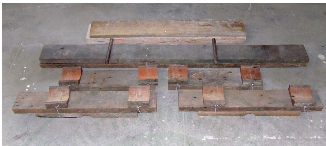
ภาพผนวกที่ 3 อุปกรณ์การทดสอบแรงคัดตามมาตรฐาน ISO22157-1
