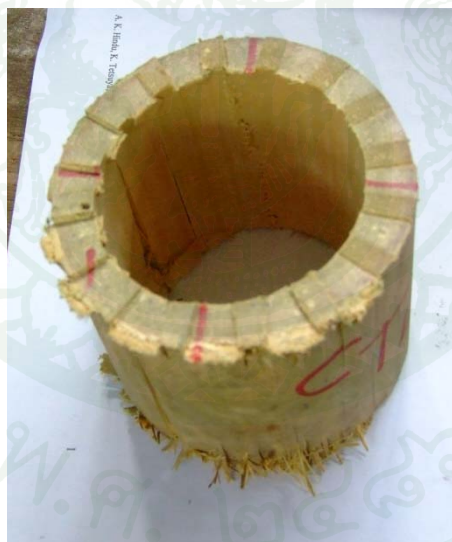
ภาพผนวกที่ 8 ตัวอย่างการวินิจฉัยจากการทดสอบแรงอัดขนานเส้น
