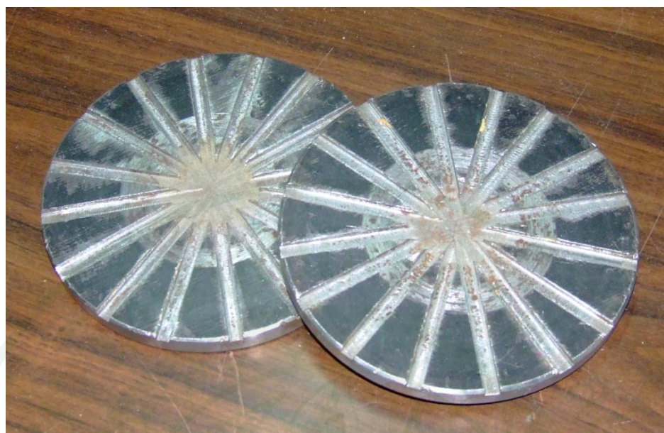
ภาพผนวกที่ 1 อุปกรณ์การทดสอบแรงอัดขนานเส้นตามมาตรฐาน ISO22157-1
