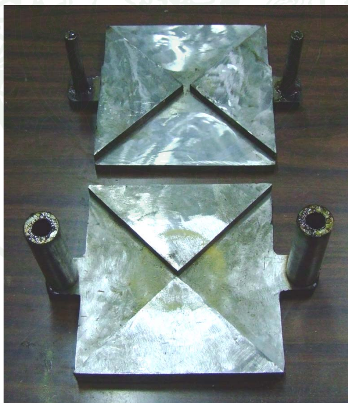
ภาพผนวกที่ 2 อุปกรณ์การทดสอบแรงเฉือนขนานเส้นตามมาตรฐาน ISO22157-1
