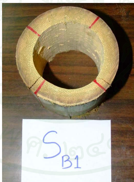
ภาพผนวกที่ 10 ตัวอย่างการวินิจฉัยจากการทดสอบแรงเฉือนขนานเส้นกรณีไม่มีข้อ
