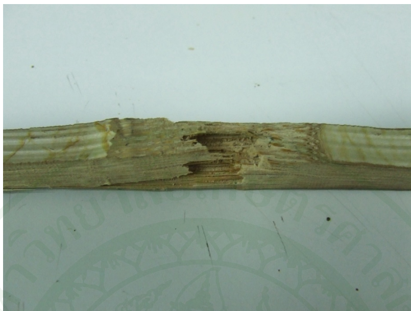
ภาพผนวกที่ 7 ตัวอย่างการวินิจฉัยจากการทดสอบแรงดึงขนานเส้น
