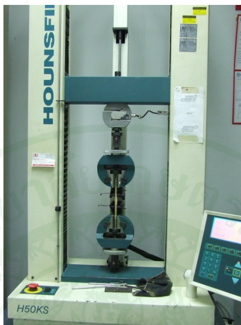
ภาพผนวกที่ 5 การทดสอบแรงดึงขนานเส้นหาความสัมพันธ์ระหว่างความเค้น-ความเครียด
