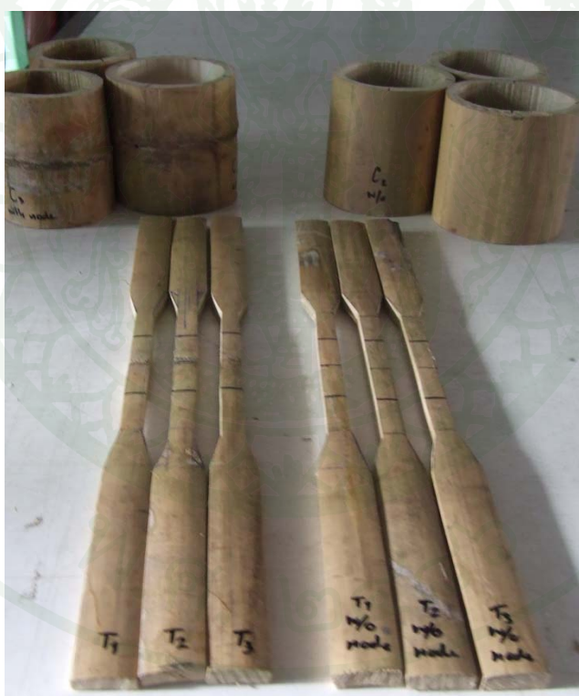
ภาพผนวกที่ 4 ชิ้นตัวอย่างสำหรับการทดสอบหาค่าความสัมพันธ์ระหว่างความเค้น-ความเครียด
