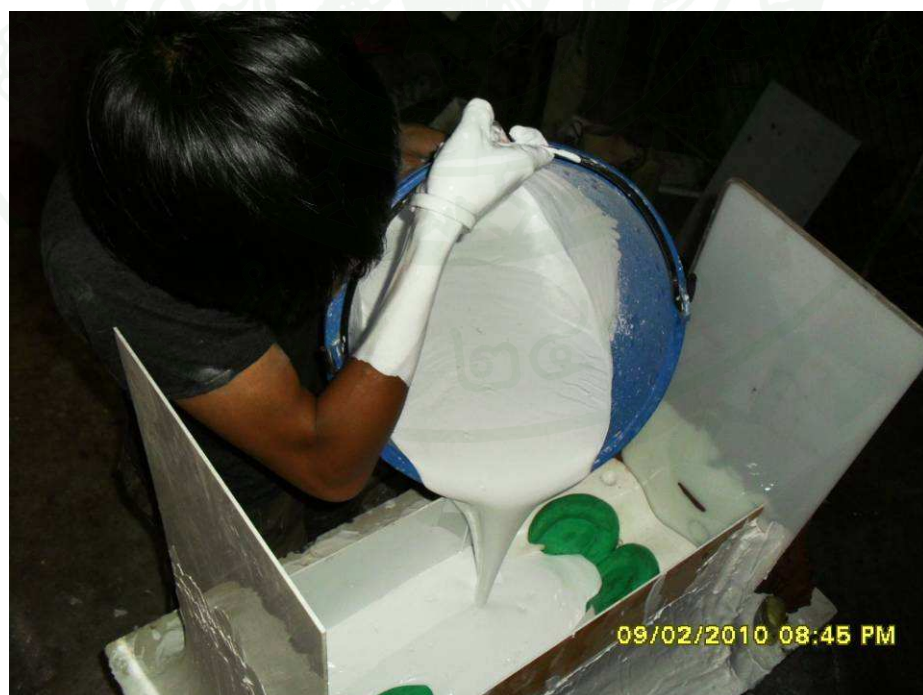
ภาพผนวกที่ 24 เทปูนปลาสเตอร์ลงไปในรูปต้นแบบให้เต็ม
