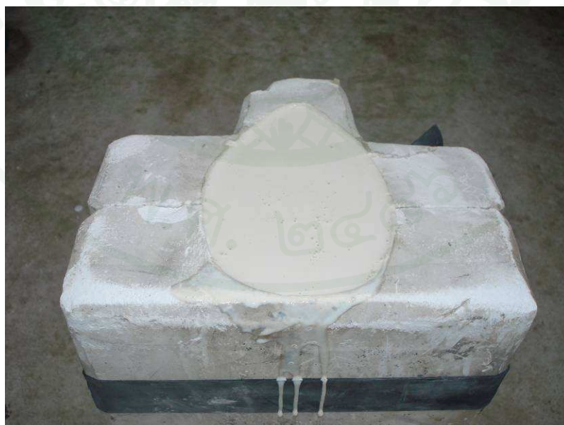
ภาพผนวกที่ 33 เทน้ำยางลงไปในพิมพ์จนเต็ม
