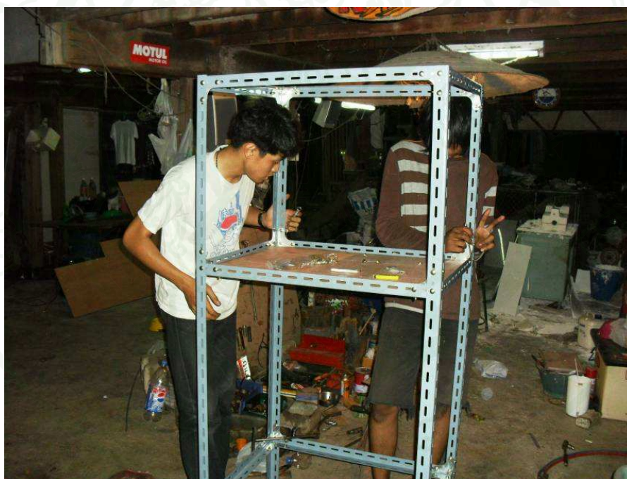
ภาพผนวกที่ 50 ประกอบโครงเหล็กฉากทั้งหมดเข้าด้วยกัน
