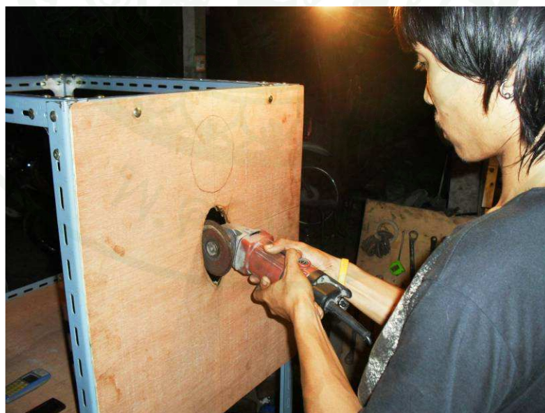
ภาพผนวกที่ 55 ใช้เครื่องมือตัดตัดไม้ออกเป็นช่องตามที่วัดไว้
