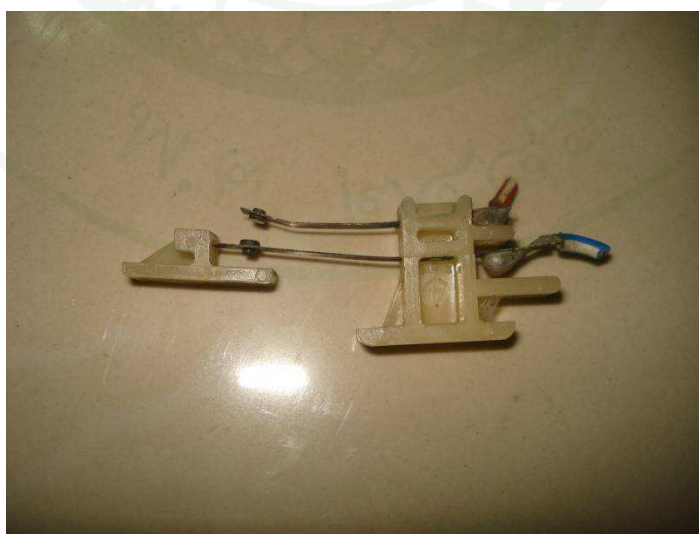
ภาพผนวกที่ 47 สวิตช์ที่ใช้ทำเป็นเซ็นเซอร์
