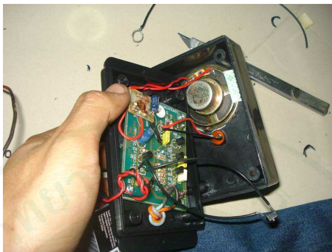
ภาพผนวกที่ 46 การประกอบแผงวงจรทั้งหมดเข้ากับกล่องอเนกประสงค์
