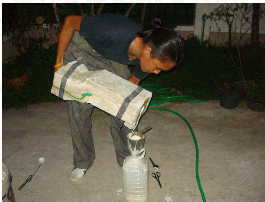
ภาพผนวกที่ 35 เทน้ำยางส่วนเกินออกจากพิมพ์
