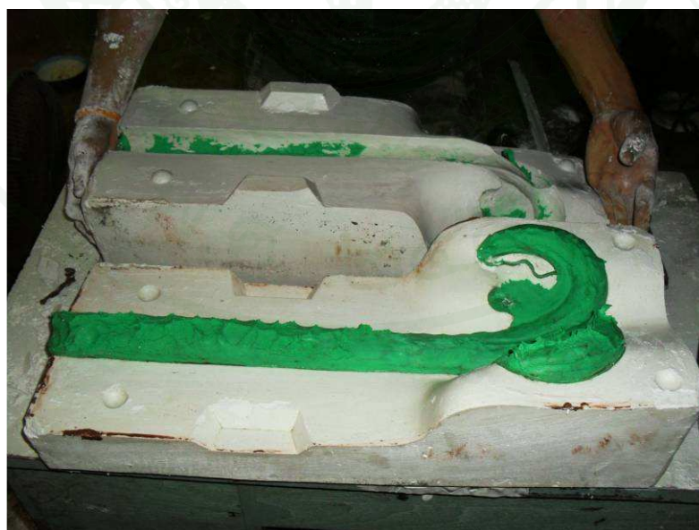
ภาพผนวกที่ 28 แกะแม่พิมพ์ออกจากกัน นำเอาต้นแบบออกจากพิมพ์
