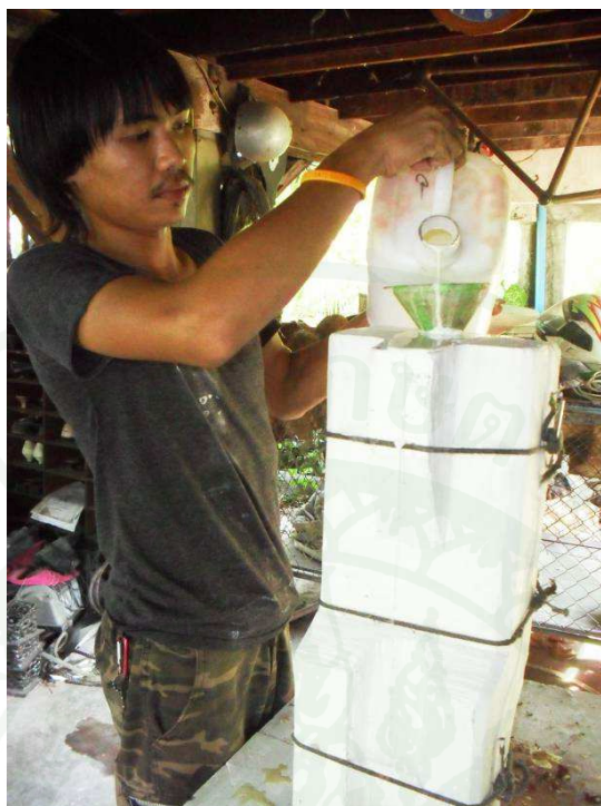
ภาพผนวกที่ 32 เทน้ำยางพาราขึ้นลงไปในพิมพ์ซ้ำๆ
