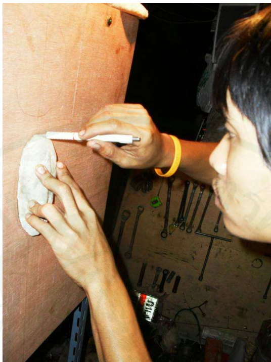
ภาพผนวกที่ 54 ใช้ปากกาลากเส้นรอบหุ่นจำลองเพื่อแสดงตำแหน่งจุดที่จะตัดไม้ออก
