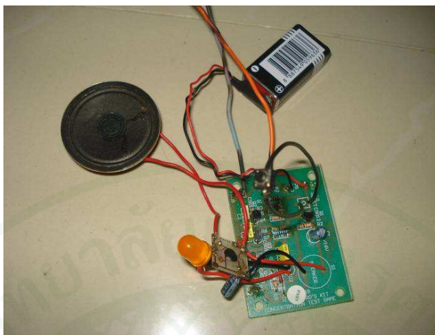
ภาพผนวกที่ 44 เปลี่ยนหลอดไฟในแผงวงจรให้ใหญ่ขึ้น
