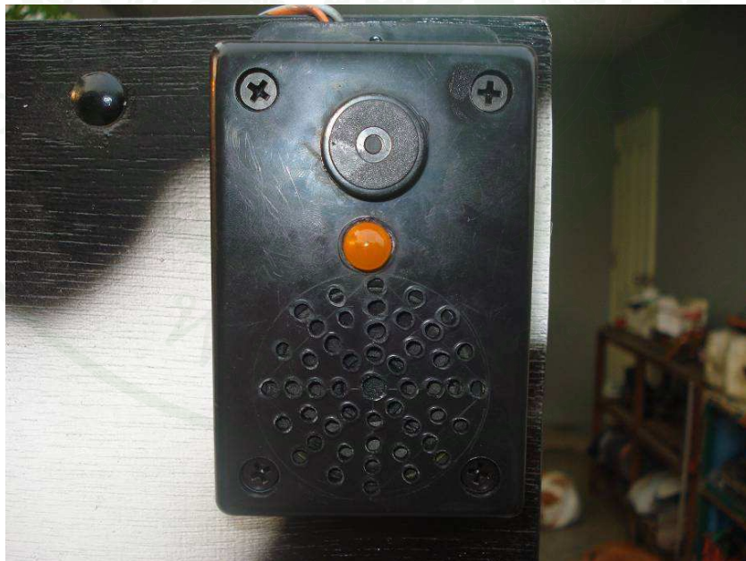
ภาพผนวกที่ 67 ติดกล่องแผงวงจรอิเล็กทรอนิกส์เข้ากับแผ่นไม้ด้านหน้าของสื่อ
