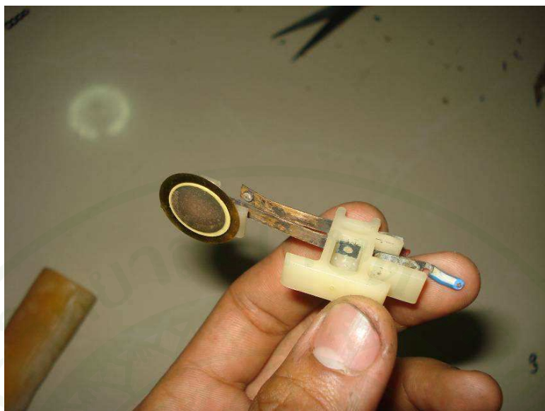
ภาพผนวกที่ 48 ติดแผ่นโลหะเพื่อเพิ่มพื้นที่สัมผัสให้กับสวิตช์เซ็นเซอร์
