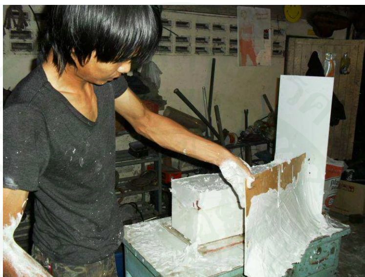
ภาพผนวกที่ 25 แกะไม้กระดานกั้นออกจากแม่พิมพ์
