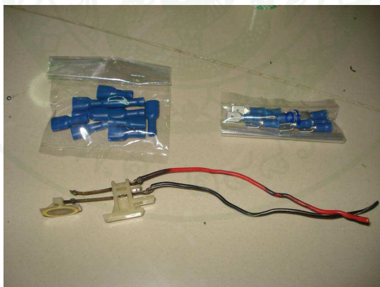
ภาพผนวกที่ 49 ต่อสายไฟที่ขาของสวิตช์เซ็นเซอร์และใส่ปลั๊กที่ปลายสาย
