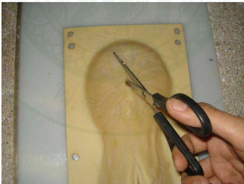
ภาพผนวกที่ 41 ตัดแต่งส่วนเกินของชิ้นงานออก
