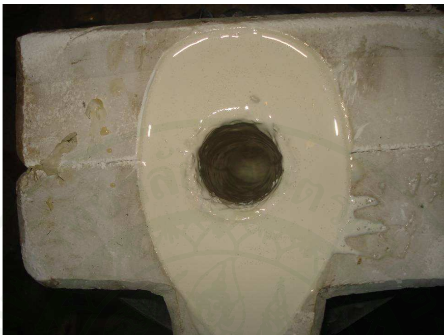
ภาพผนวกที่ 36 ภายในพิมพ์เมื่อเทน้ำยางส่วนเกินออกหมด
