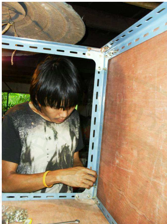
ภาพผนวกที่ 53 เจาะรูไม้อัดเพื่อใช้เป็นรูร้อยนอตสำหรับยึดติดกับโครงเหล็กฐาน
