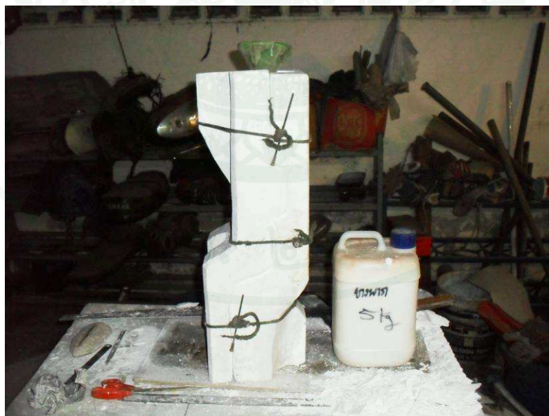
ภาพผนวกที่ 31 นำแม่พิมพ์ทั้งสองชิ้นมาประกบกันแล้วมัดไว้ด้วยยางยืด
