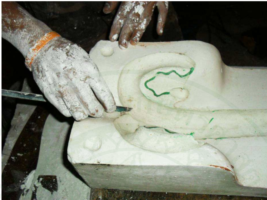
ภาพผนวกที่ 29 ขุดแต่งส่วนเกินของพิมพ์ด้วยเครื่องมือ
