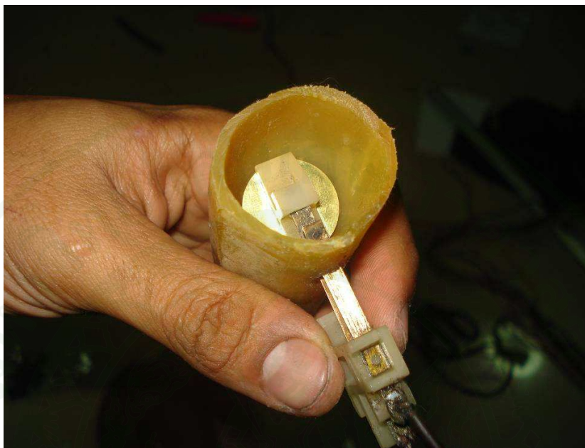
ภาพผนวกที่ 60 ประกอบสวิตช์เซ็นเซอร์เข้ากับหุ่นจำลองส่วนคอมดลูก
