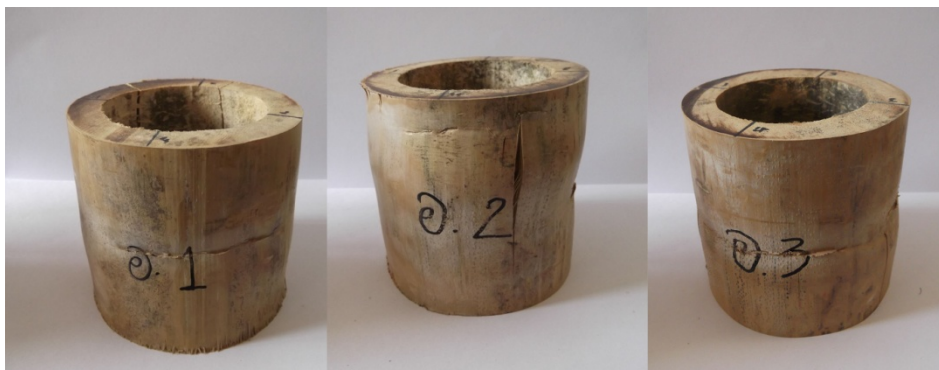
ภาพที่ ก-2 ลักษณะการวิบัติการทดสอบแรงอัด
