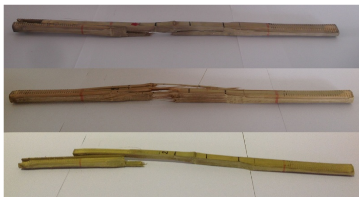
ภาพที่ ก-1 ลักษณะการวิบัติการทดสอบแรงดึง
