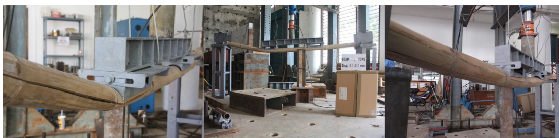
ภาพที่ ก-4 ลักษณะการปฏิบัติการทดสอบแรงดัด
