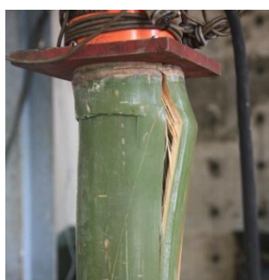
ลักษณะการวิบัติแบบ Bearing (1)
