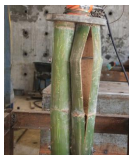
ลักษณะการวิบัติแบบ Splits (2)
