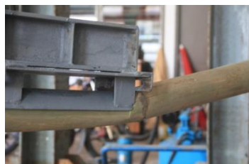
การวิบัติแบบ Local crushing (1)
