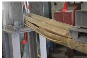
การวิบัติแบบ Splitting (2)
