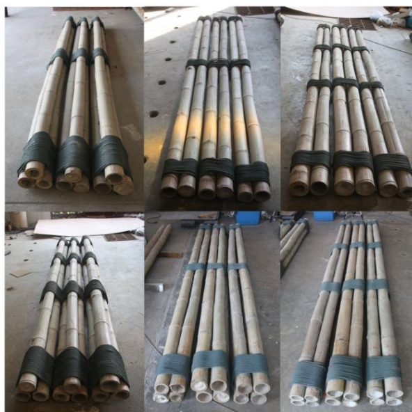
ทดสอบขึ้นตัวอย่างแบบที่ 2-4 โดยใช้วิธีการไ้้ล้มแล้วมัดด้วยเชือกไนลอน (1)
