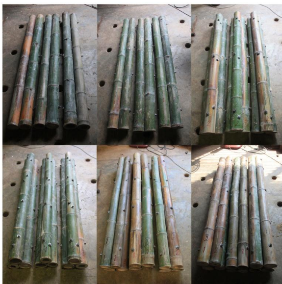
ทดสอบขึ้นตัวอย่างแบบที่ 2-4 โดยใช้วิธีการไ้้นอตเกลียว (2)
