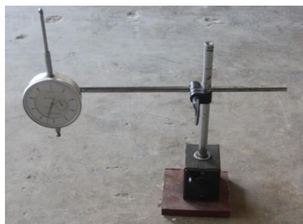
ภาพที่ 3.63 เครื่องมือทดสอบตามมาตรฐาน ISO-22157-1
