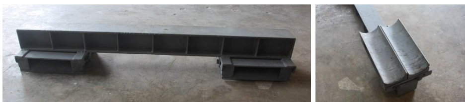
ภาพที่ 3.63 เครื่องมือทดสอบตามมาตรฐาน ISO-22157-1
