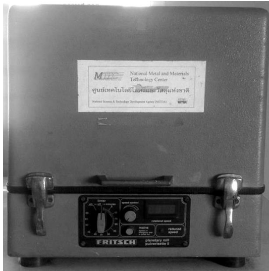
รูปที่ 3.1 เครื่องบดแนวตั้ง บริษัท FRITSCH รุ่น 8.6580
