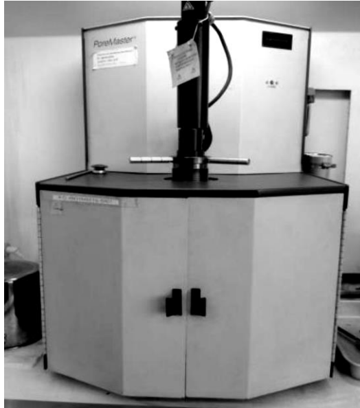
รูปที่ 3.4 เครื่องวิเคราะห์ขนาดรูพรุน และการกระจายตัวของรูพรุน
