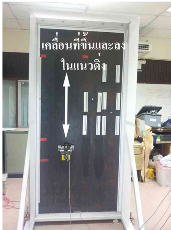
รูปที่ 3.14 รูปแบบและลักษณะของการทดสอบความสามารถในการไต่ขึ้นและลงบนผนังเหล็กของหุ่นยนต์ล้อยแม่เหล็ก
