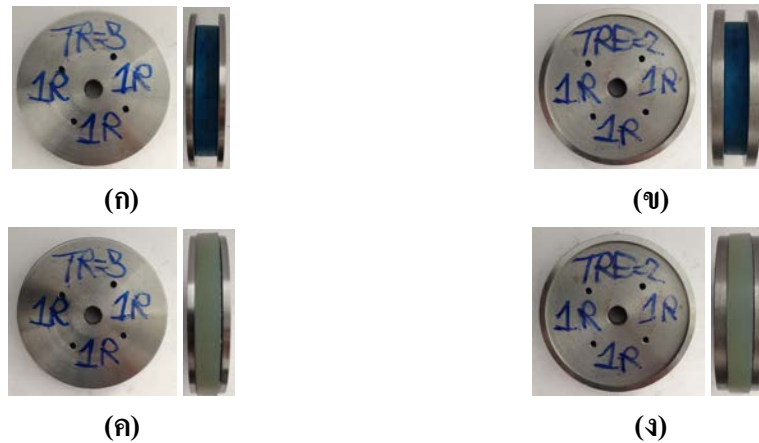
รูปที่ 3.6 ตัวอย่างล้อแม่เหล็ก : (ก) กระดาษล้อปกติ (ข) กระดาษล้อที่มีขอบเพิ่มเติม (ค) กระดาษล้อปกติ และยางล้อชนิดซิลิโคน (ง) กระดาษล้อที่มีขอบเพิ่มเติมและยางล้อชนิดยางซิลิโคน
