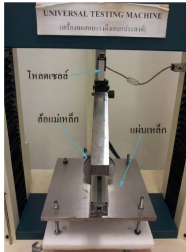
รูปที่ 3.11 ชุดการทดลองวัดค่าแรงยึดเกาะของล้อยแม่เหล็กโดยใช้เครื่องทดสอบแรงดึงเอกประสงค์ (Universal tensile test)
