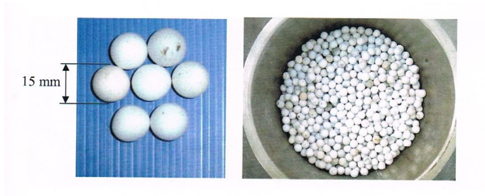
รูปที่ ก.3 Alumina spheres with particle diameter of d = 0.015 m (porous medium)
